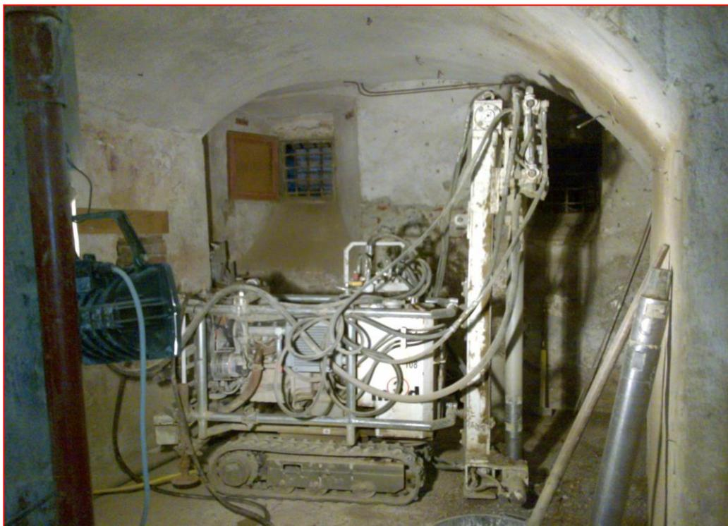
Un volta eseguita perforazione il foro sarà attrezzato mediante una tubazione in PVC e per il manto drenante sarà utilizzato esclusivamente un ghiaino siliceo calibrato.
