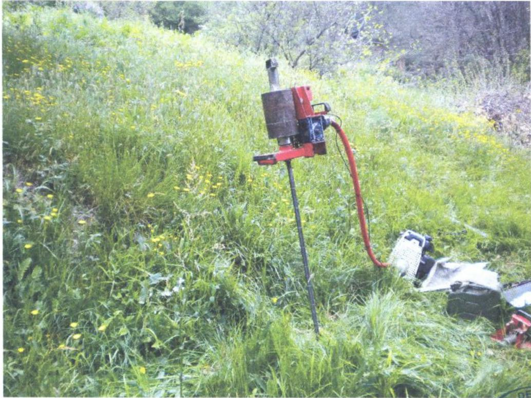
Fotografia n° 15 – Prova penetrometrica dinamica PPD10.
