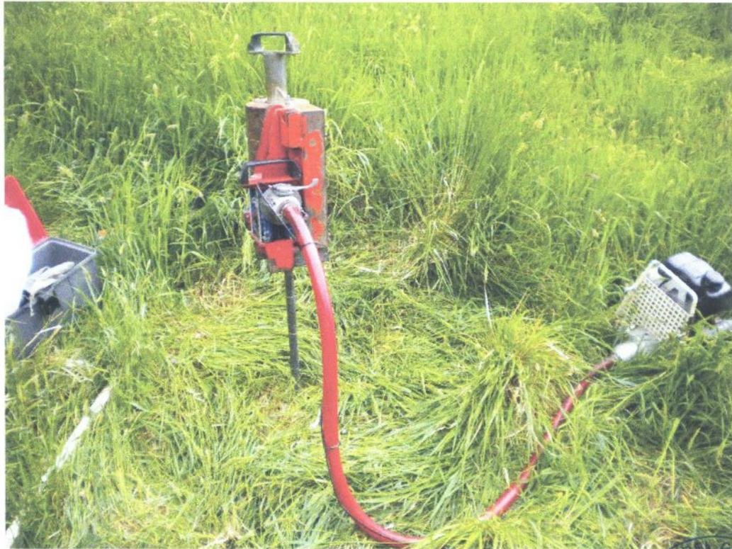
Fotografia n° 11 – Prova penetrometrica dinamica PPD6.
