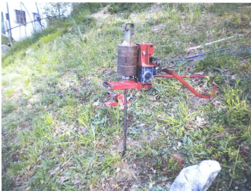
Fotografia n° 7 – Prova penetrometrica dinamica PPD2.
