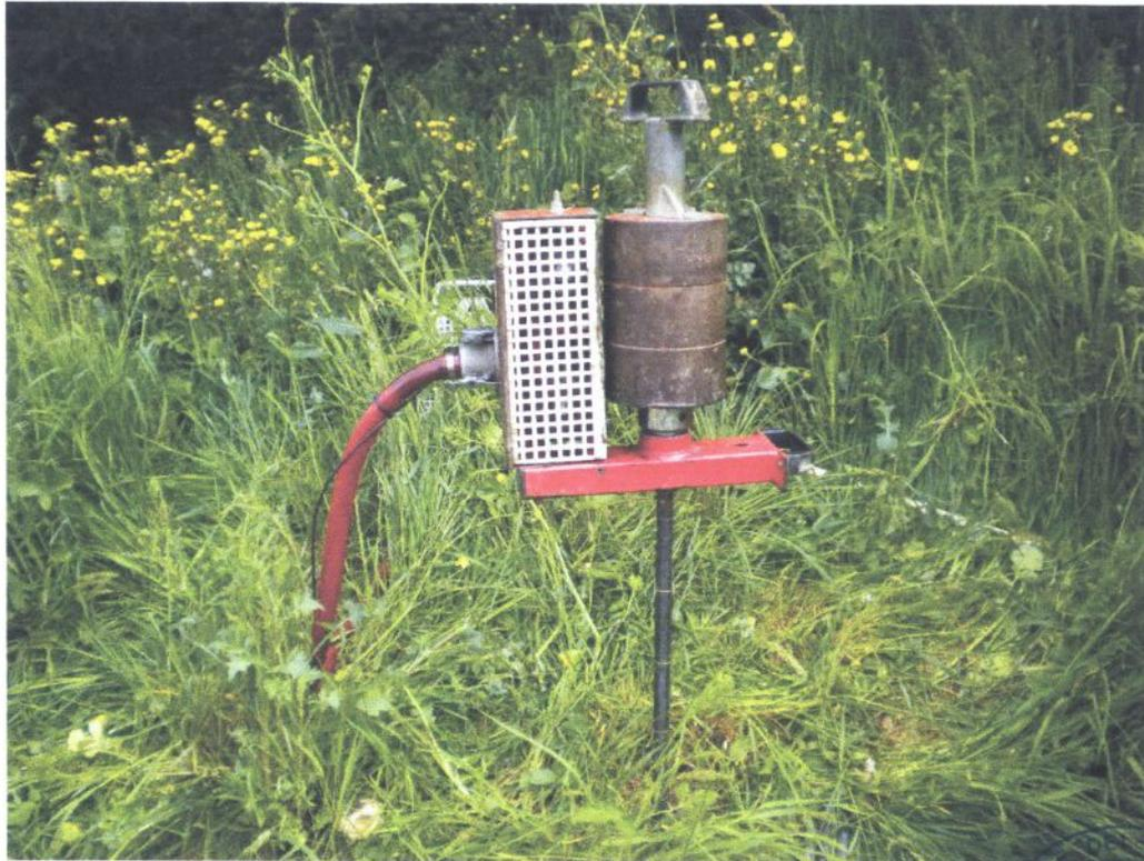
Fotografia n° 9 – Prova penetrometrica dinamica PPD4.
