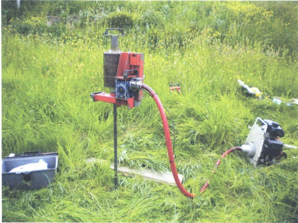
Fotografia n° 13 – Prova penetrometrica dinamica PPD8.
