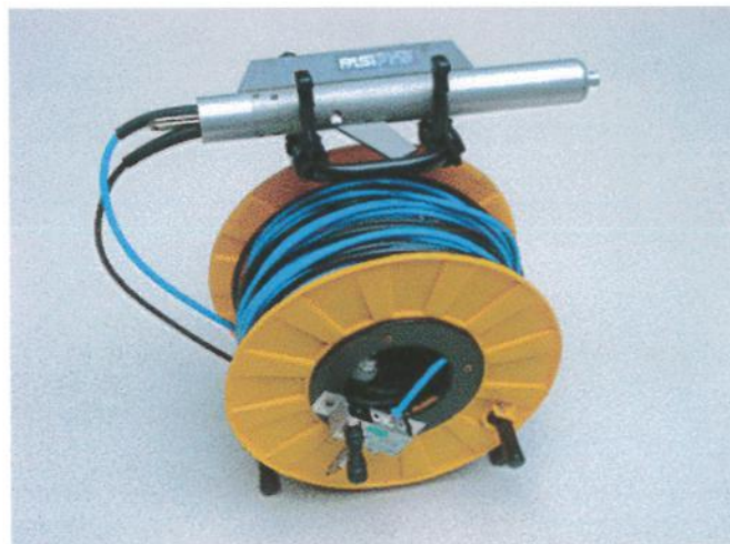
Geofono tridimensionale da foro PASI GFA
