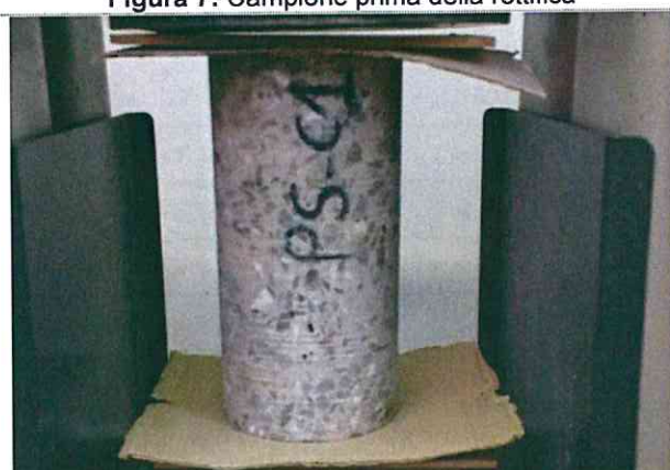
Figura 9: Campione prima della prova a compressione
