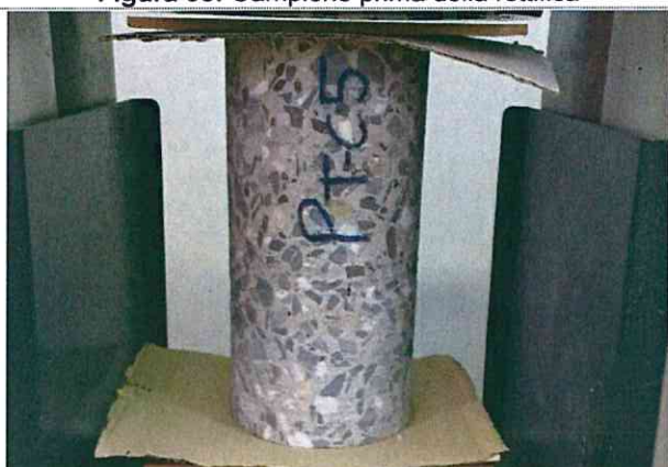
Figura 40: Campione prima della prova a compressione
