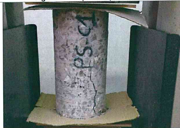
Figura 10: Campione dopo la prova a compressione
