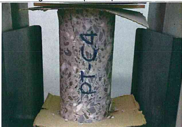
Figura 37: Campione dopo la prova a compressione
