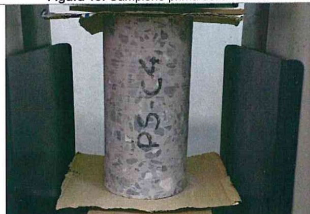
Figura 20: Campione prima della prova a compressione
