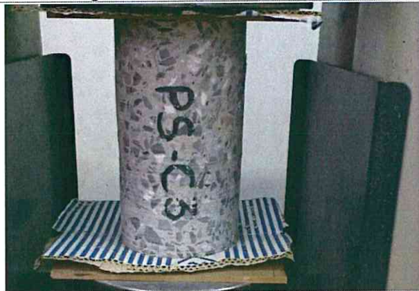
Figura 17: Campione dopo la prova a compressione
