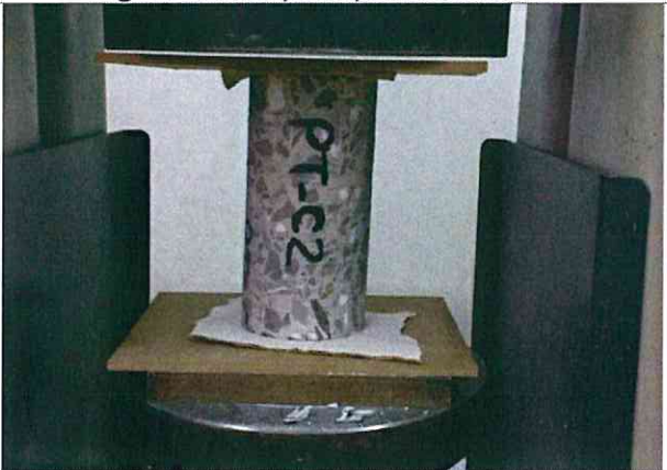
Figura 28: Campione prima della prova a compressione
