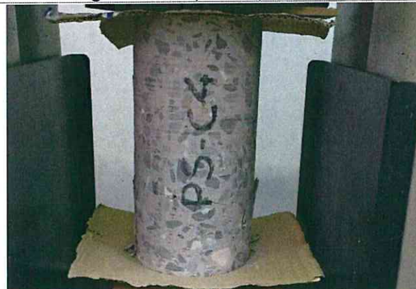
Figura 21: Campione dopo la prova a compressione
