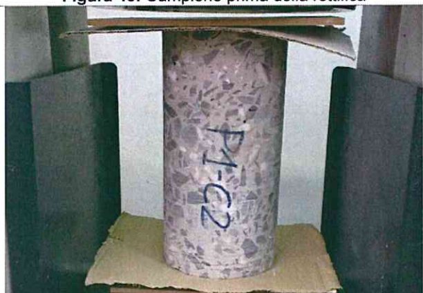
Figura 48: Campione prima della prova a compressione
