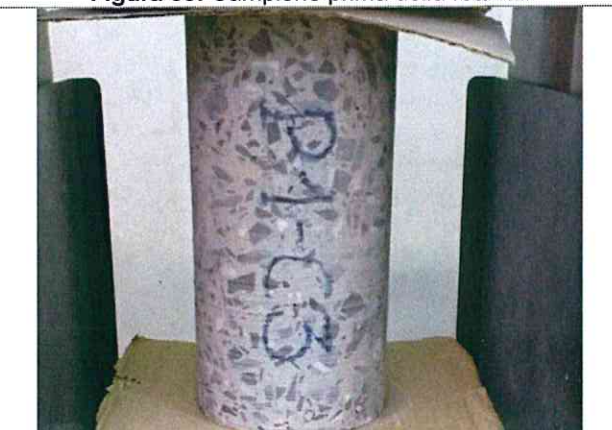
Figura 52: Campione prima della prova a compressione
