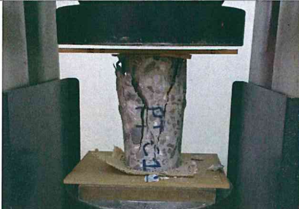
Figura 25: Campione dopo la prova a compressione
