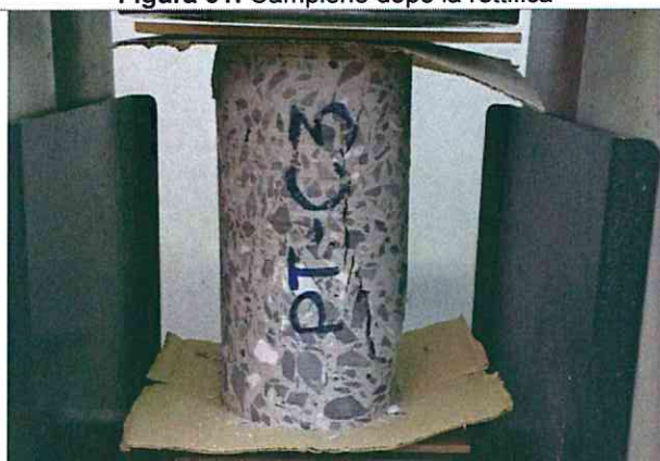
Figura 33: Campione dopo la prova a compressione
