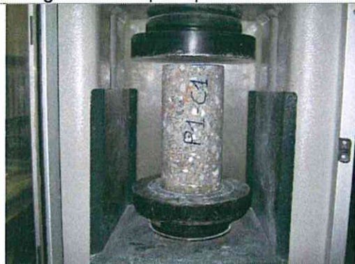
Figura 44: Campione prima della prova a compressione
