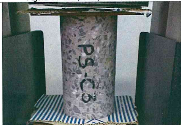
Figura 16: Campione prima della prova a compressione
