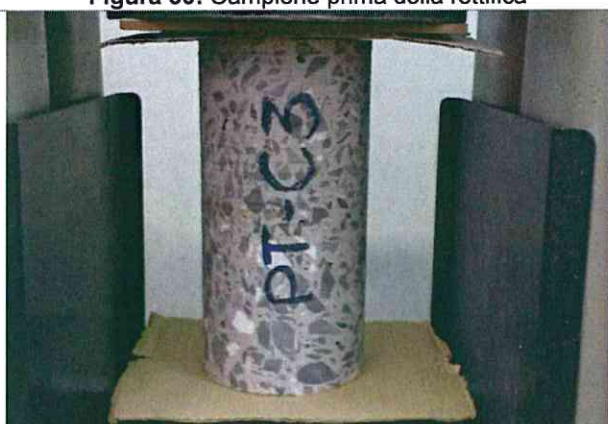
Figura 32: Campione prima della prova a compressione
