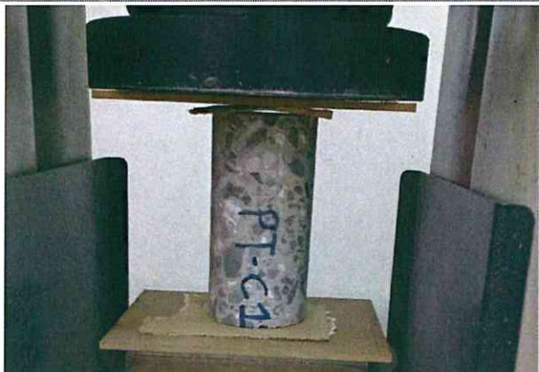
Figura 24: Campione prima della prova a compressione
