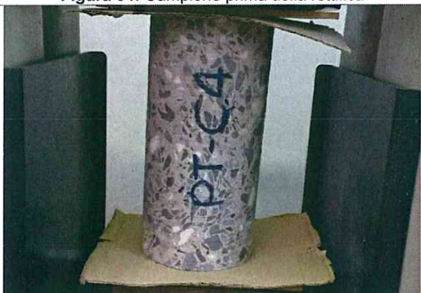
Figura 36: Campione prima della prova a compressione
