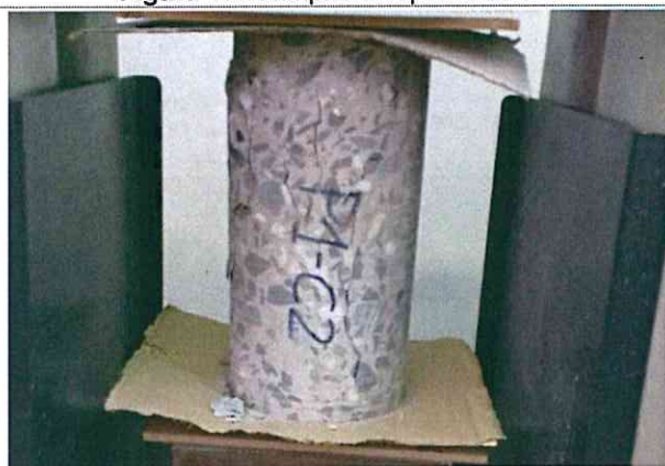
Figura 49: Campione dopo la prova a compressione
