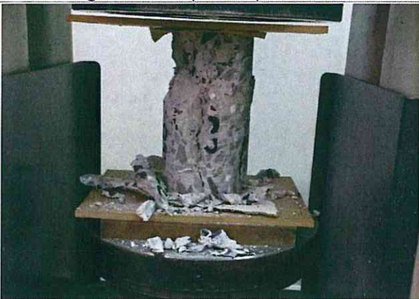
Figura 29: Campione dopo la prova a compressione
