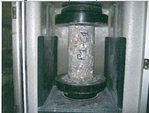
Figura 45: Campione dopo la prova a compressione
