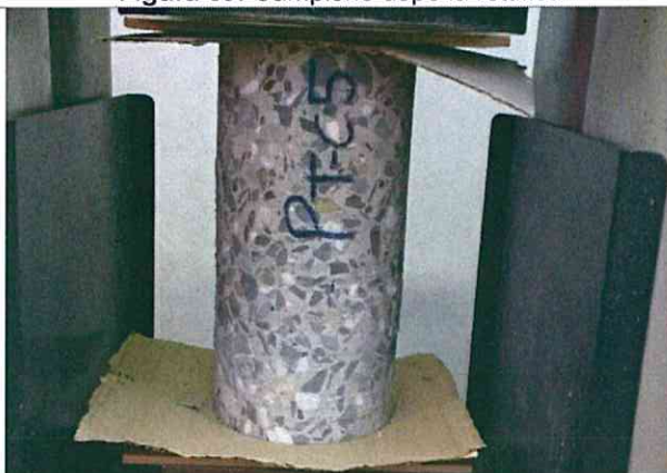
Figura 41: Campione dopo la prova a compressione
