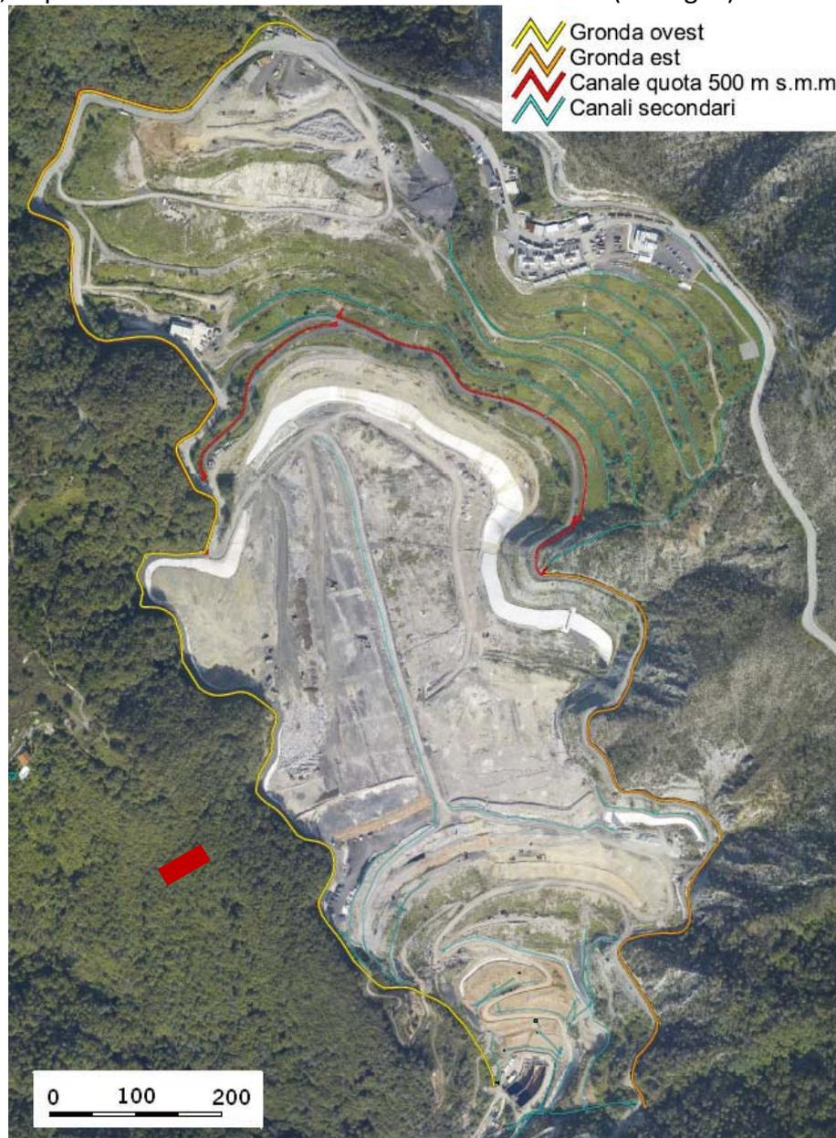
Figura 4: Sistema di raccolta e allontanamento delle acque superficiali; ■ = possibile localizzazione impianto depurazione
