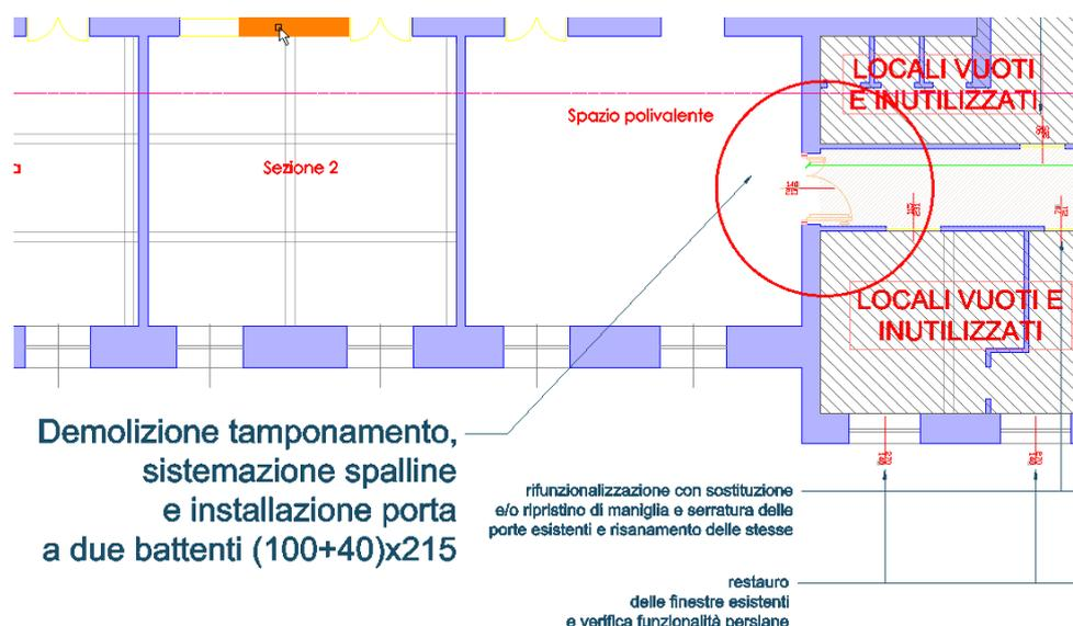
**Figura 8.** Dettaglio della localizzazione dell'apertura varco al piano secondo.
