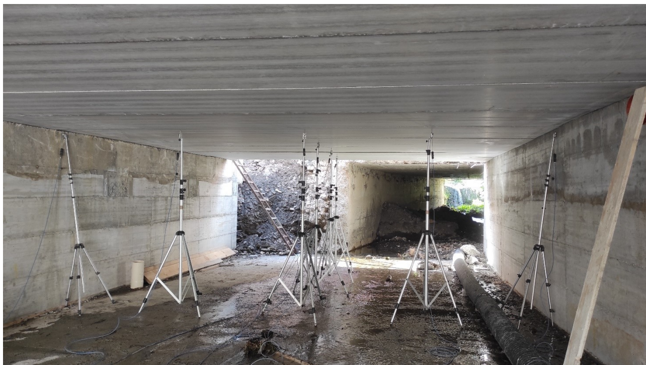
Foto 3 - Comparatori in posizione durante la prova.
