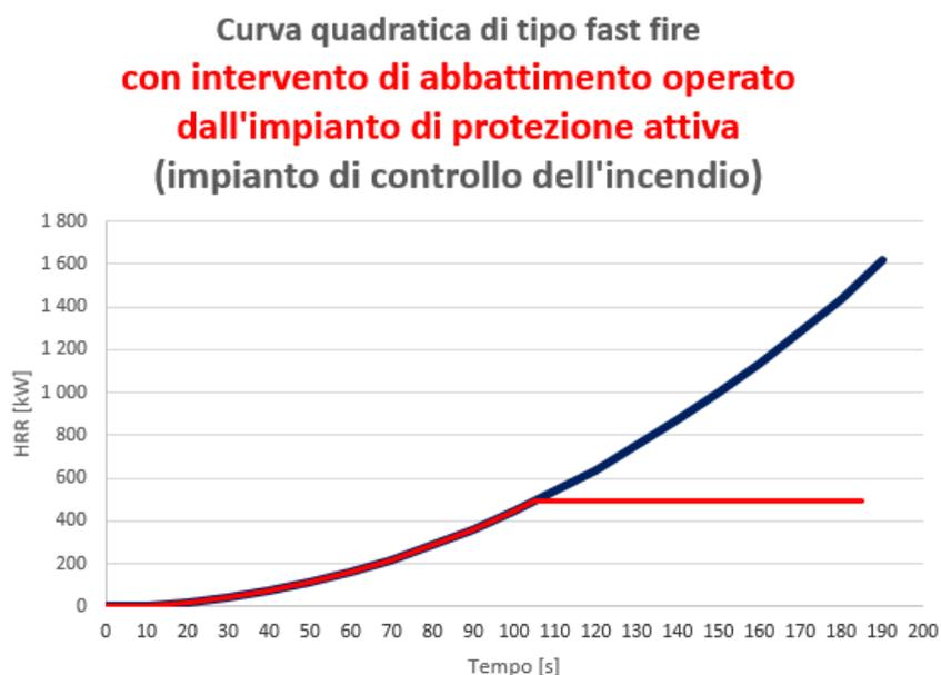
*Abbattimento della potenza rilasciata HRR(t) operato dall'impianto di controllo sulla curva quadratica presa a campione*
