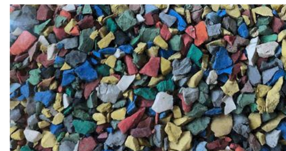
Pavimentazione in gomma 100% EPDM in granuli multicolore di gradevole impatto visivo
