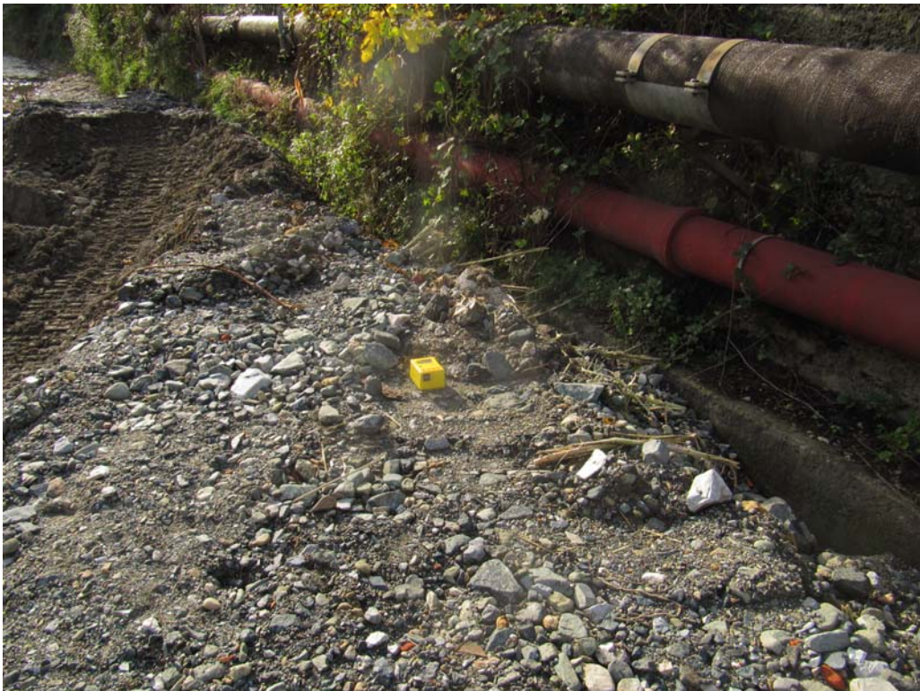
Fotografia n° 2 – Indagine sismica con Tromino.
