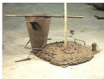
Consistenza S5 slump > 220 mm
