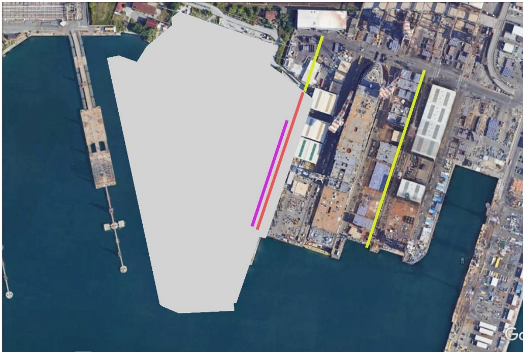
Figura 26 Posizione binari gru a cavalletto: in viola i binari della gru da 200ton, in rosso i binari della gru a cavalletto inclusi nel presente progetto, in giallo i binari della gru a cavalletto non inclusi nel presente progetto
