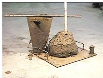
Consistenza S3 slump 100 - 150 mm
