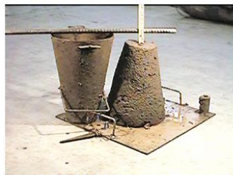
Consistenza S1 slump 10 - 40 mm
