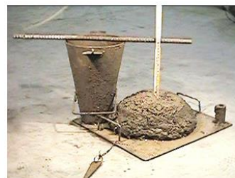
Consistenza S4 slump 160 - 210 mm
