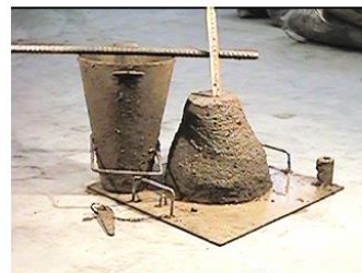
Consistenza S2 slump 50 - 90 mm
