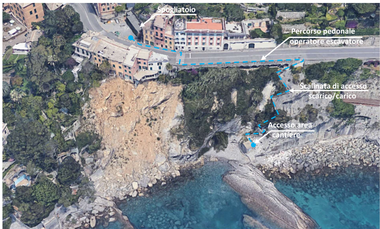
Figura 8: immagini aeree del litorale con indicazione di accesso al cantiere tramite percorso pedonale
