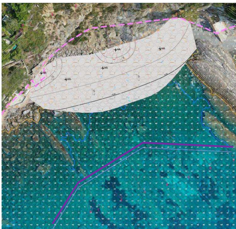
Figura 8.1: stralcio planimetria di progetto con ortofoto e indicazione della fascia di rispetto bionaturalistica (in viola)
