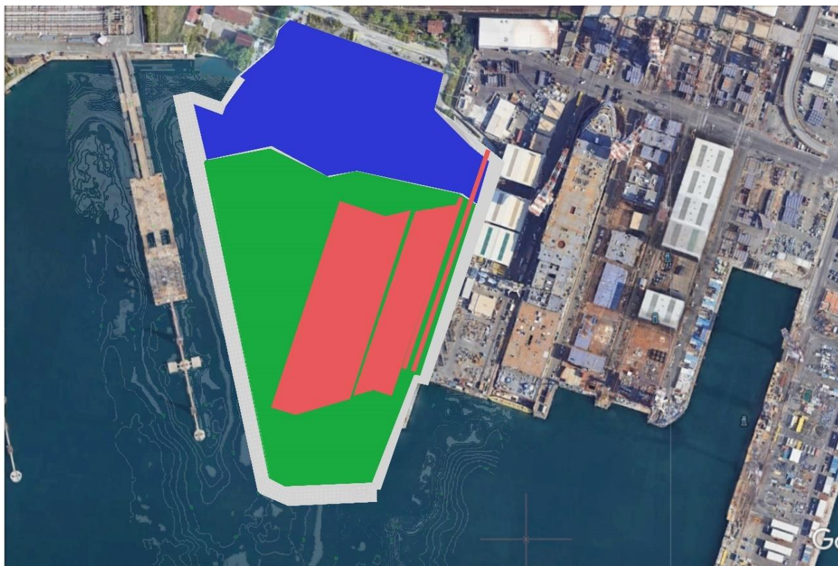
Figura 1: Planimetria di progetto Cassa di Colmata con evidenziate le diverse fasi di consegna. In verde e rosso la parte della cassa di colmata completata in data 30.11.2023, in azzurro la parte della cassa di colmata oggetto del presente appalto.
