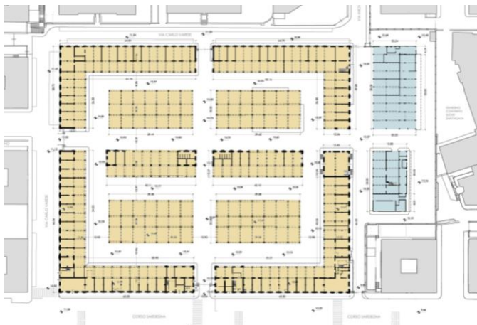
Planimetria dello stato di fatto: in colore beige gli edifici storici degli anni '20, in azzurro i capannoni recenti
