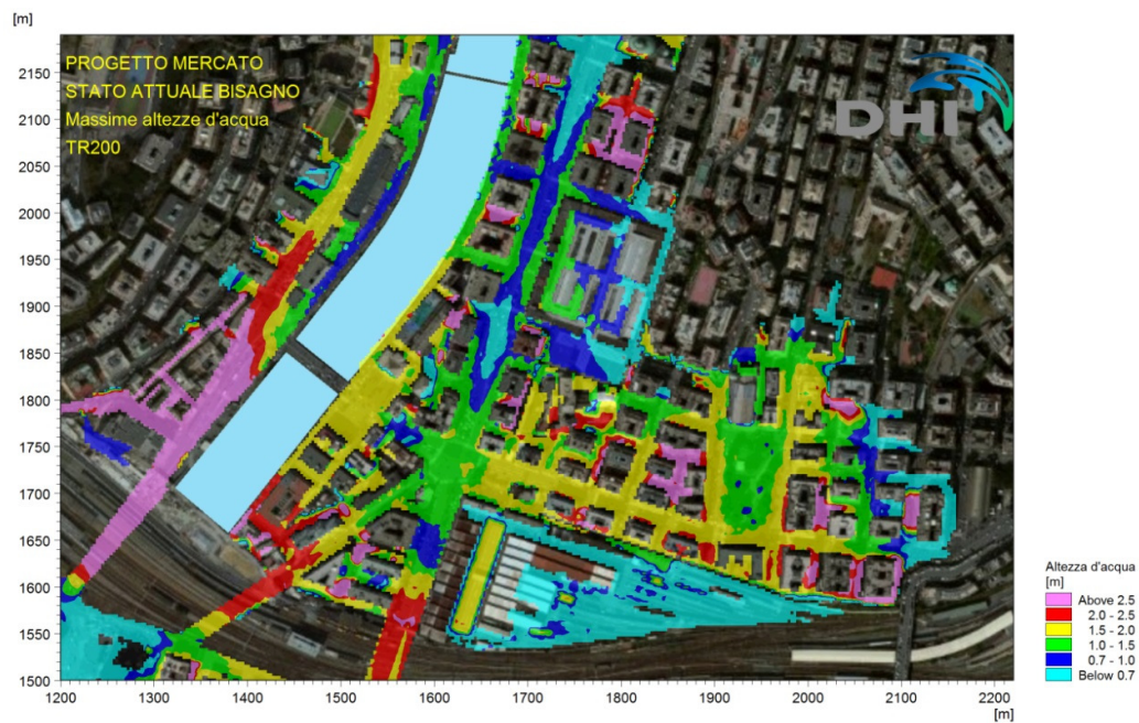
Figura 4.13 Torrente Bisagno – Massimi tiranti idrici degli allagamenti nelle aree in prossimità dell'ex Mercato Generale (configurazione di progetto) per effetto di un evento di piena con tempo di ritorno 200 anni.
