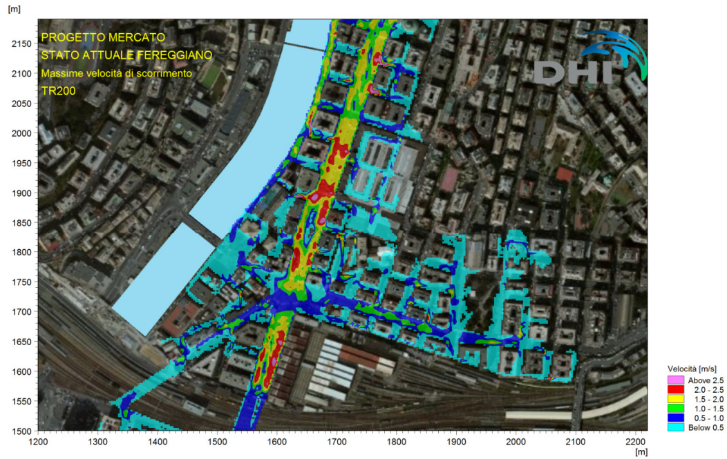
Figura 4.17 Rio Fereggiano – Massime velocità di scorrimento degli allagamenti nelle aree in prossimità dell'ex Mercato Generale (configurazione di progetto) per effetto di un evento di piena con tempo di ritorno 200 anni.
