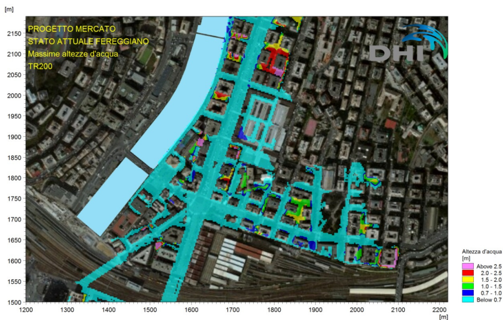
Figura 4.16 Rio Fereggiano – Massimi tiranti idrici degli allagamenti nelle aree in prossimità dell'ex Mercato Generale (configurazione di progetto) per effetto di un evento di piena con tempo di ritorno 200 anni.
