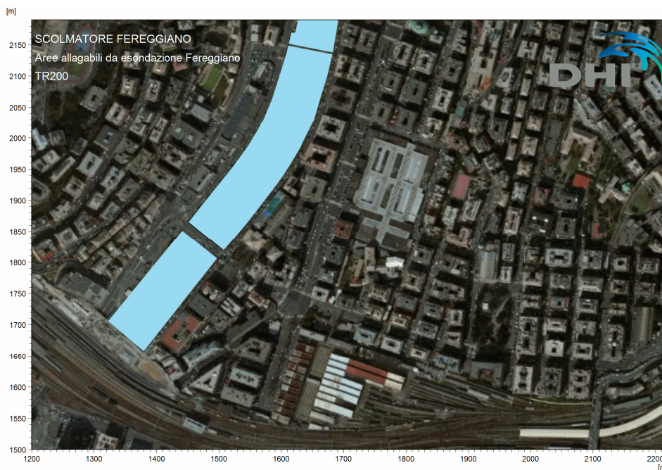
Figura 4.5 Rio Fereggiano – Aree soggette ad allagamento in prossimità dell'ex Mercato Generale per effetto di un evento di piena con tempo di ritorno 200 anni, a seguito della realizzazione dello scolmatore del rio Fereggiano (assenza di allagamenti).
