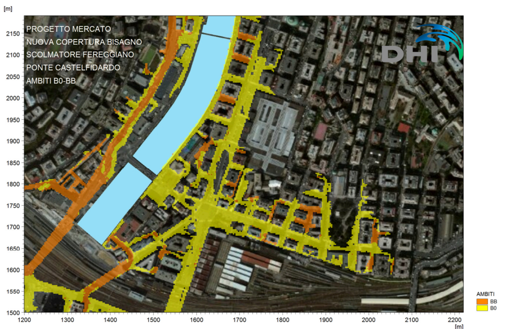
Figura 4.24 Torrente Bisagno – Combinazione dei valori massimi di tiranti idrici e velocità di scorrimento degli allagamenti dell'evento di piena duecentennale, secondo il criterio di definizione degli ambiti normativi di Fascia B, nelle aree in prossimità dell'ex Mercato Generale (configurazione di progetto), a seguito del completamento degli interventi relativi alla copertura terminale del Bisagno, allo scolmatore del Fereggiano e al ponte Castelfidardo.
