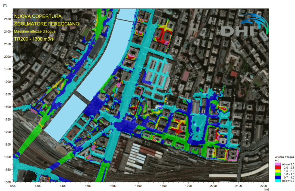
Figura 4.6 Torrente Bisagno – Massimi tiranti idrici degli allagamenti nelle aree in prossimità dell'ex Mercato Generale per effetto di un evento di piena con tempo di ritorno 200 anni, a seguito del completamento degli interventi di rifacimento della copertura terminale del torrente Bisagno e di realizzazione dello scolmatore del rio Fereggiano.
