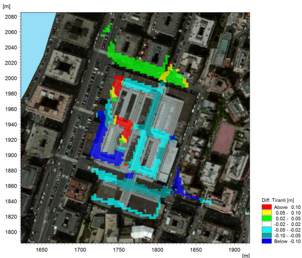
Figura 5.2 Differenza di tiranti idrici degli allagamenti dovuti a un evento di piena duecentennale del Bisagno nella configurazione di realizzazione della copertura terminale, tra stato di progetto a seguito di variazione morfologica meno stato attuale delle aree dell'ex Mercato Generale.
