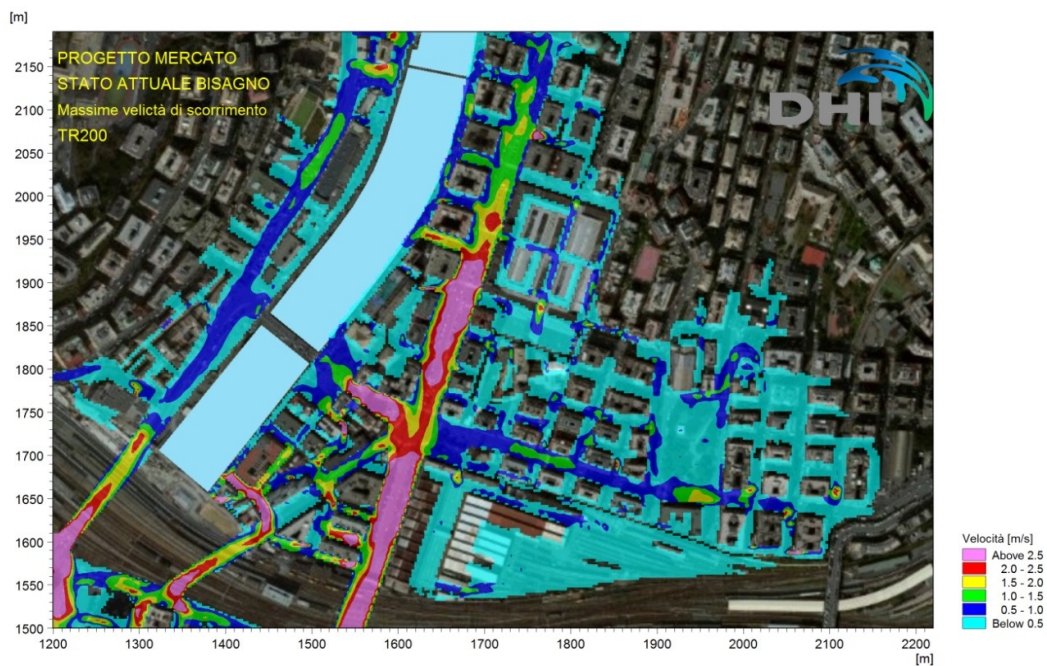
Figura 4.14 Torrente Bisagno – Massime velocità di scorrimento degli allagamenti nelle aree in prossimità dell'ex Mercato Generale (configurazione di progetto) per effetto di un evento di piena con tempo di ritorno 200 anni.
