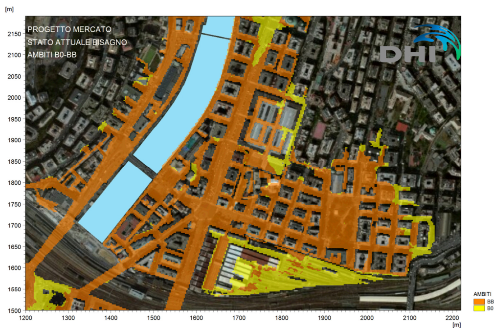
Figura 4.15 Torrente Bisagno – Combinazione dei valori massimi di tiranti idrici e velocità di scorrimento degli allagamenti dell'evento di piena duecentennale, secondo il criterio di definizione degli ambiti normativi di Fascia B, nelle aree in prossimità dell'ex Mercato Generale (configurazione di progetto).
