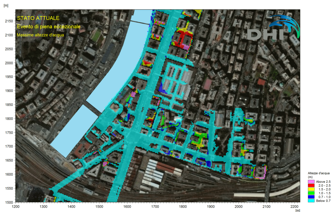
Figura 3.5 Rio Fereggiano – Massimi tiranti idrici degli allagamenti nelle aree in prossimità dell'ex Mercato Generale per effetto di un evento di piena con tempo di ritorno 200 anni.
