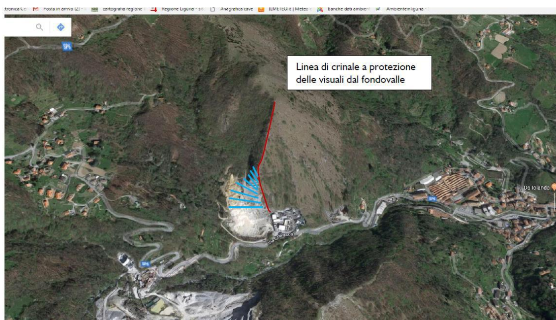
Figura 3 – Schema nuova linea di orientamento dei gradoni superiori di cava
