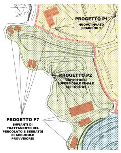
L'impianto per il trattamento del percolato è costituito da due moduli indipendenti, dimensionati per trattare una portata di percolato in ingresso pari a 100 m<sup>3</sup>/h.
