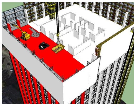
Ponteggio autodiscendente schermato e gru di servizio
