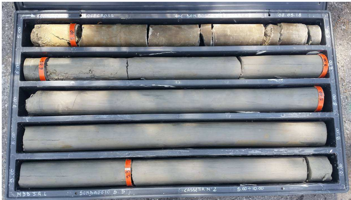
Sondaggio S5-cassetta N°2- da 5.0 m a 10.0 m
