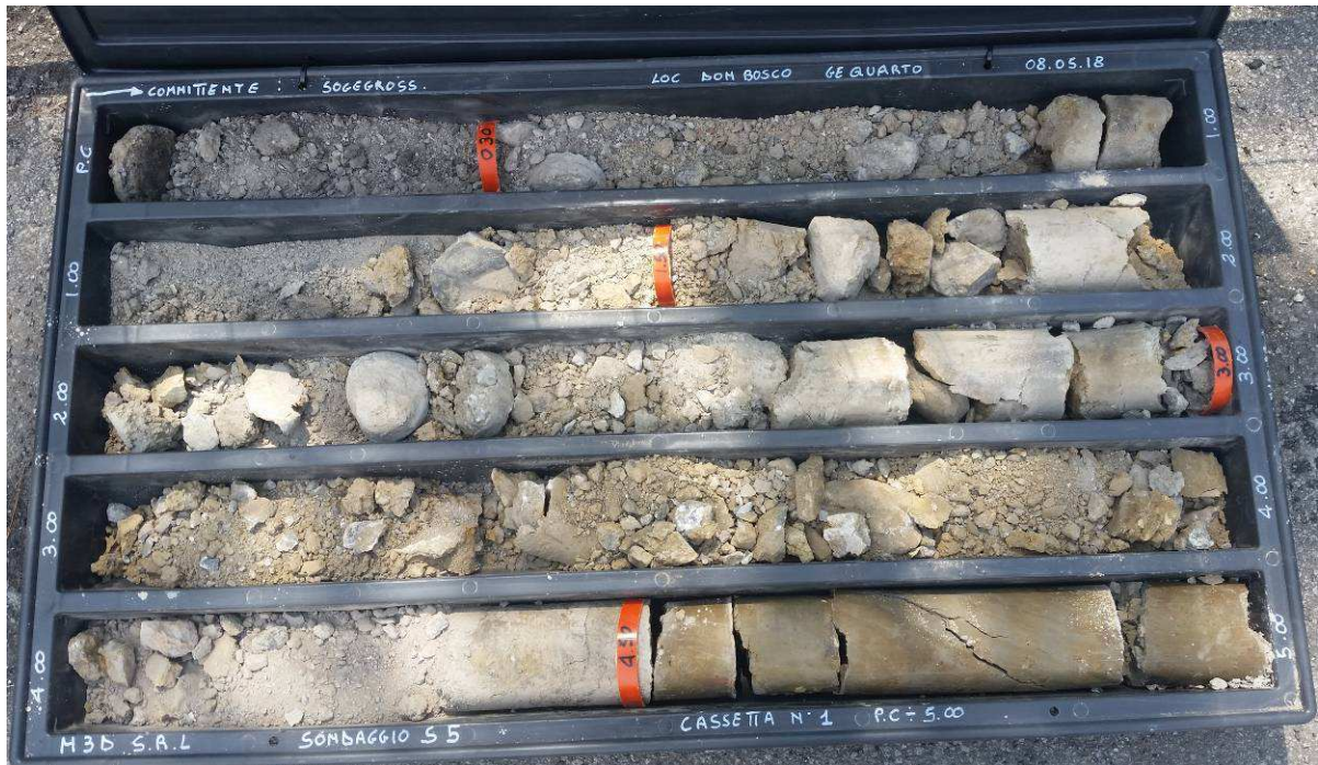
Sondaggio S5-cassetta N°1- da 0.0 m a 5.0 m
