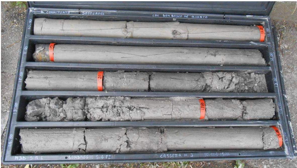
Sondaggio S4-cassetta N°3- da 5.0 m a 10.0 m
