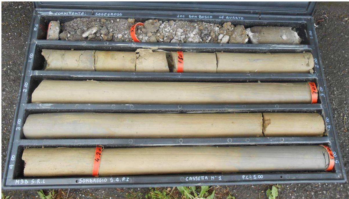
Sondaggio S4-cassetta N°1- da 0.0 m a 5.0 m
