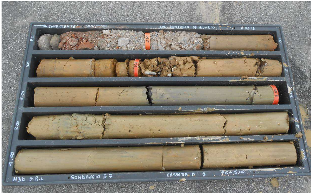
Sondaggio S7-cassetta N°1- da 0.0 m a 5.0 m
