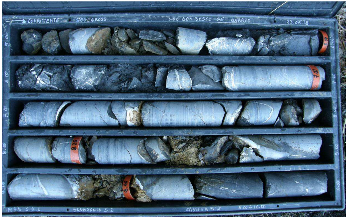
Sondaggio S2-cassetta N°2- da 5.0 m a 10.0 m
