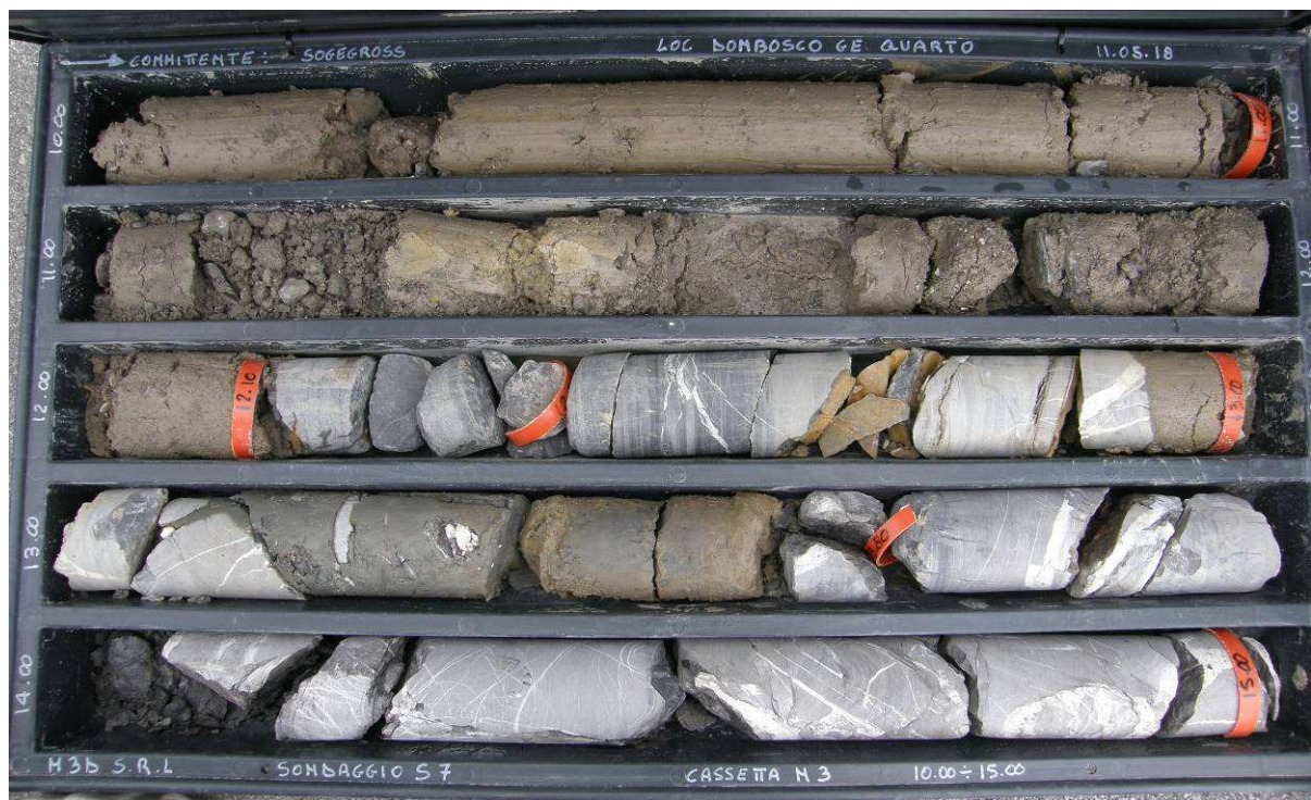
Sondaggio S7-cassetta N°3- da 10.0 m a 15.0 m
