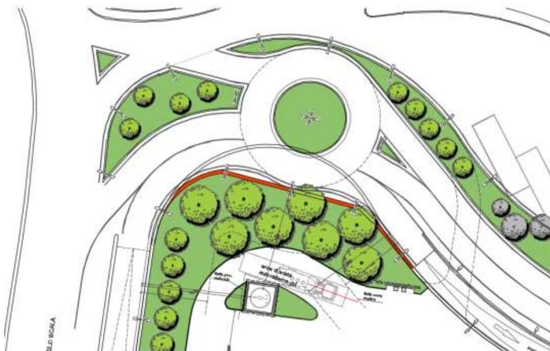
Figura 3: Tracciamento nuovo muro in rosso
