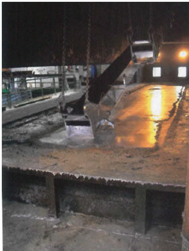
Esempio di esplosione durante l'immersione dell'elemento nel bagno di zinco fuso a causa di un'intercapedine non forata (Fonte: Manuale di buone pratiche per la zincatura a caldo - A.I.Z.)
