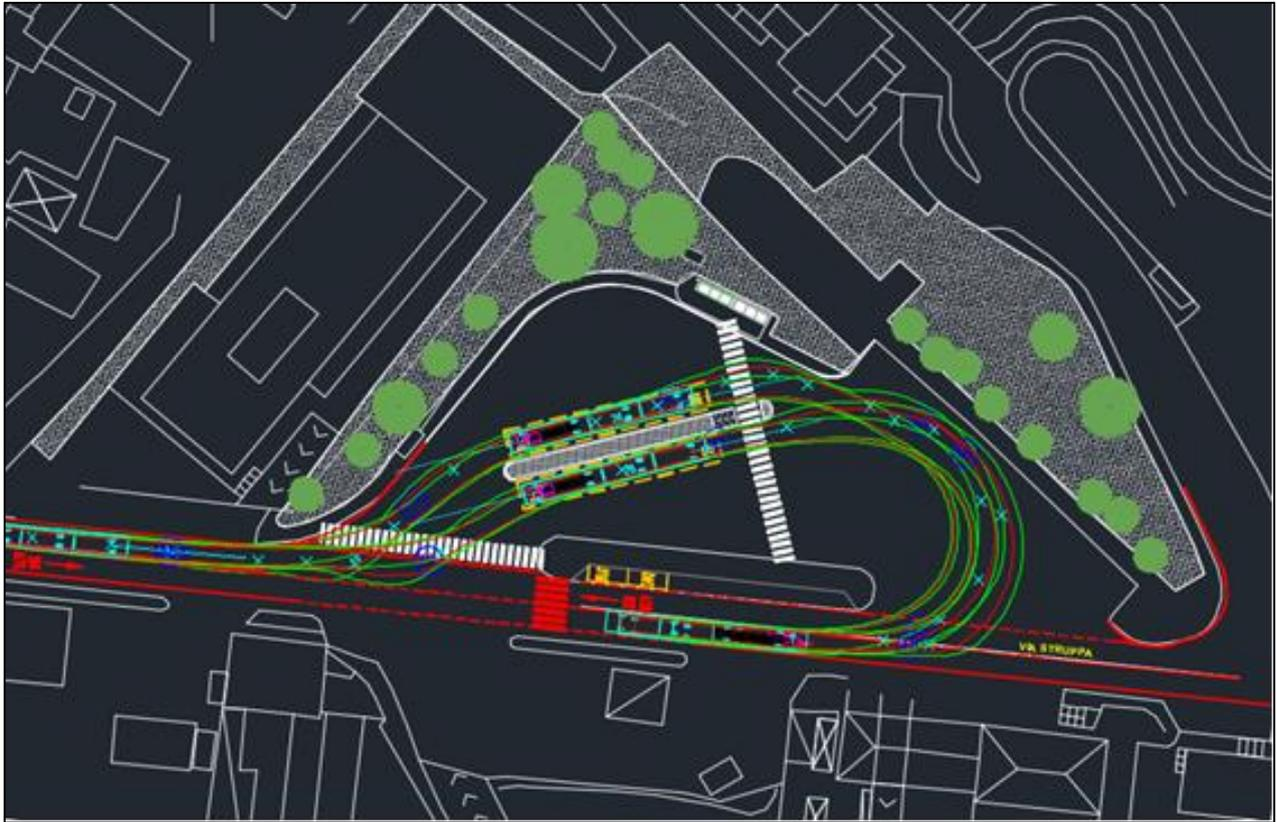
Figura 3 – Esempio di verifica ingombro in curva con utilizzo del software “vehicle tracking”
