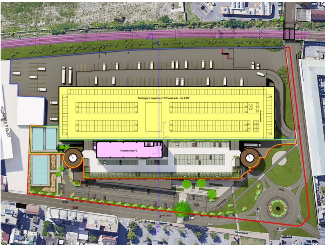
Schema planimetrico del Piano terzo con evidenziate le funzioni previste (parcheggio logistica in giallo e terziario in rosa).
