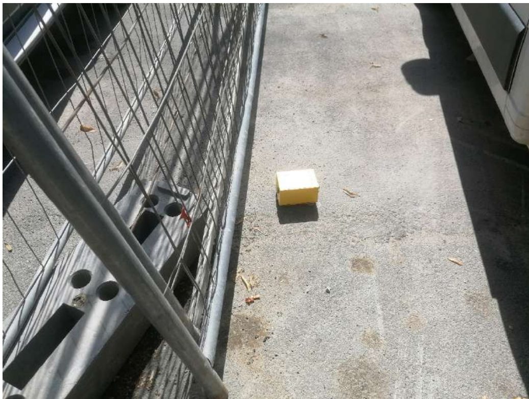
Fotografia n. 6 - Prova sismica HVSR (tromino) T3.
