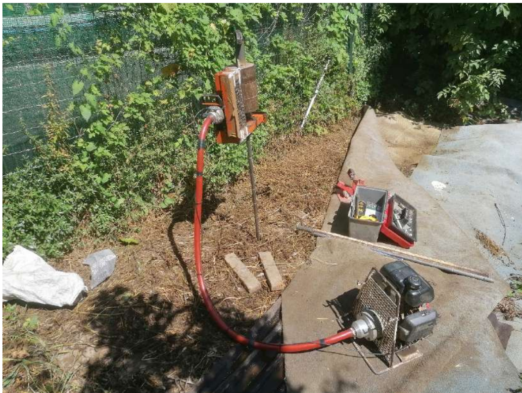
Fotografia n. 5 - Prova penetrometrica dinamica media PPD1.
