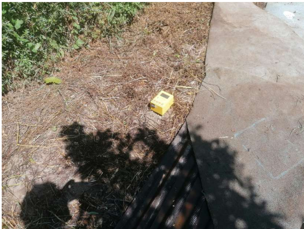
Fotografia n. 7 - Prova sismica HVSR (tromino) T4.
