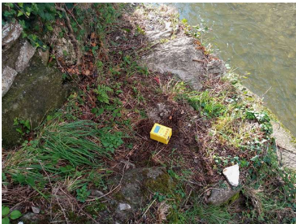
Fotografia n. 3 - Prova sismica HVSR (tromino) T1.
