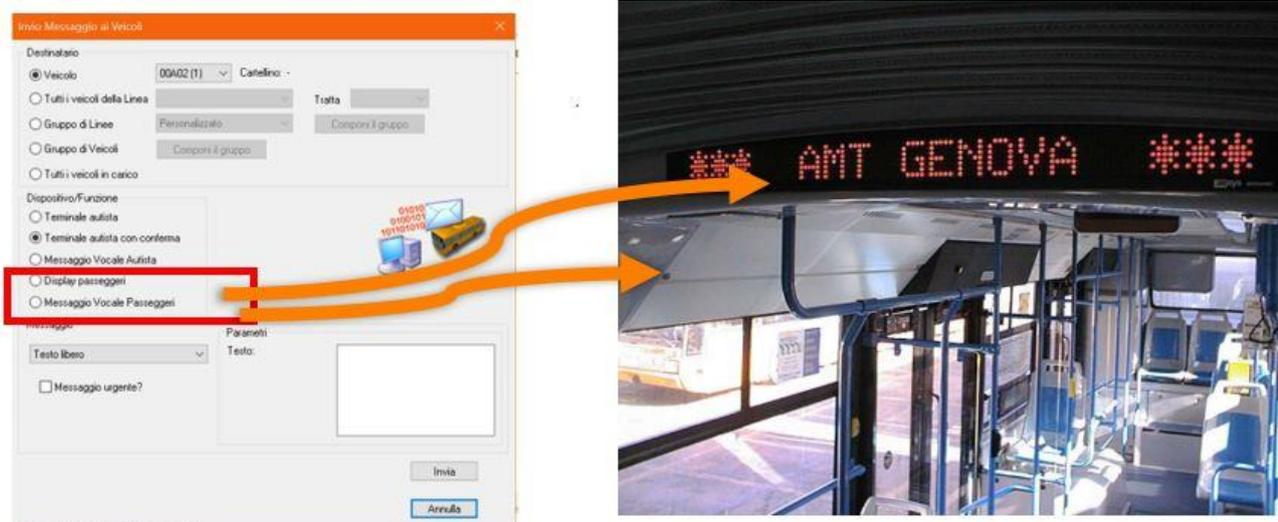
Figura 17– Esempio di Messaggi digitali inviabili ad una Vettura
