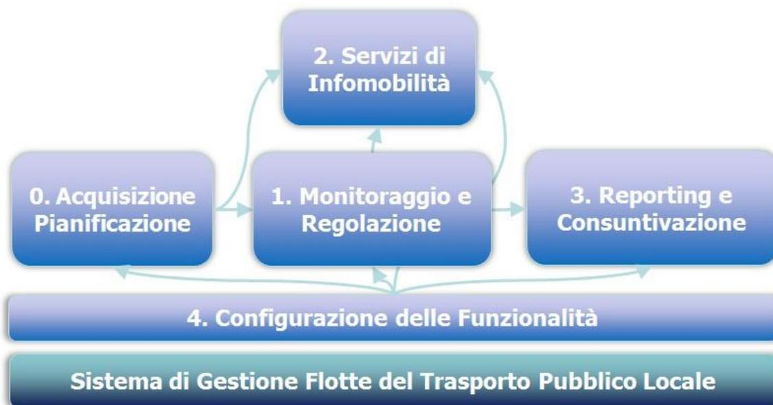
Figura 7 – Principali macro-funzionalità di un sistema di gestione di flotte del trasporto pubblico locale
