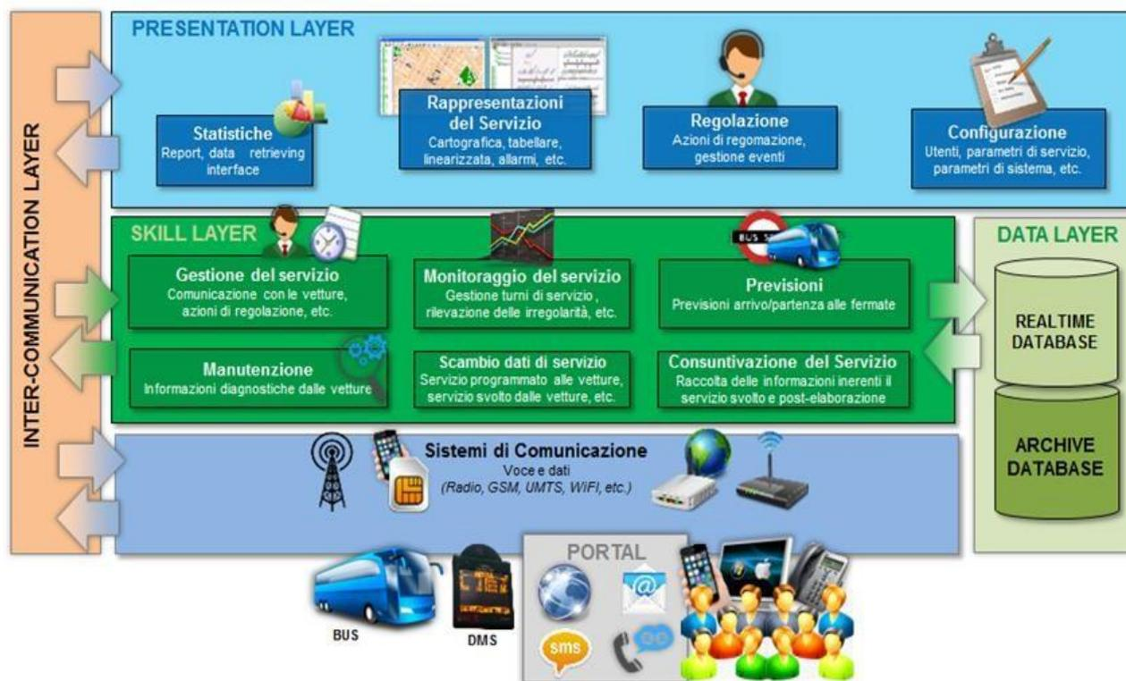
Figura 6 – Schema a blocchi funzionale del Sistema di Centrale AVM SIMON
