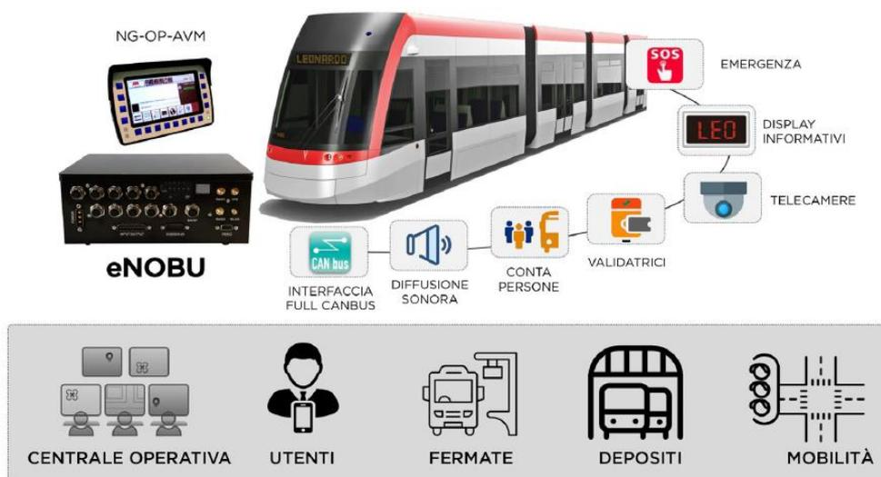
Figura 1 – Schematizzazione Architettura Apparati terra e bordo
