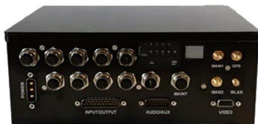
Figura 16– Videoregistratore di Bordo – NVR – eNOBU
