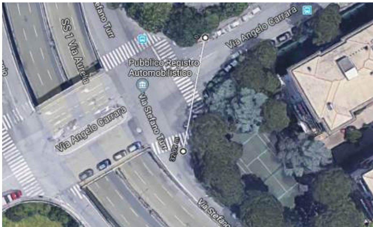
Figura 39. Distanza visibilità accesso da via Turr
