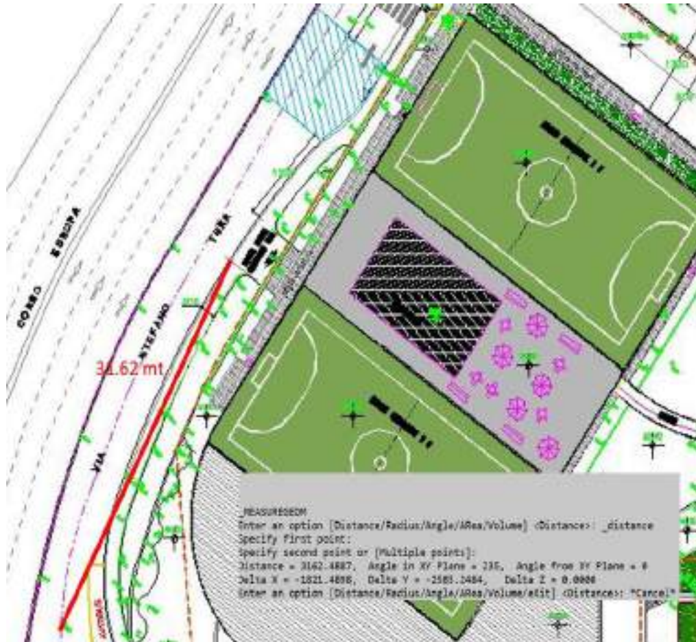
Figura 42. Distanza visibilità dell'accesso su via Turr
