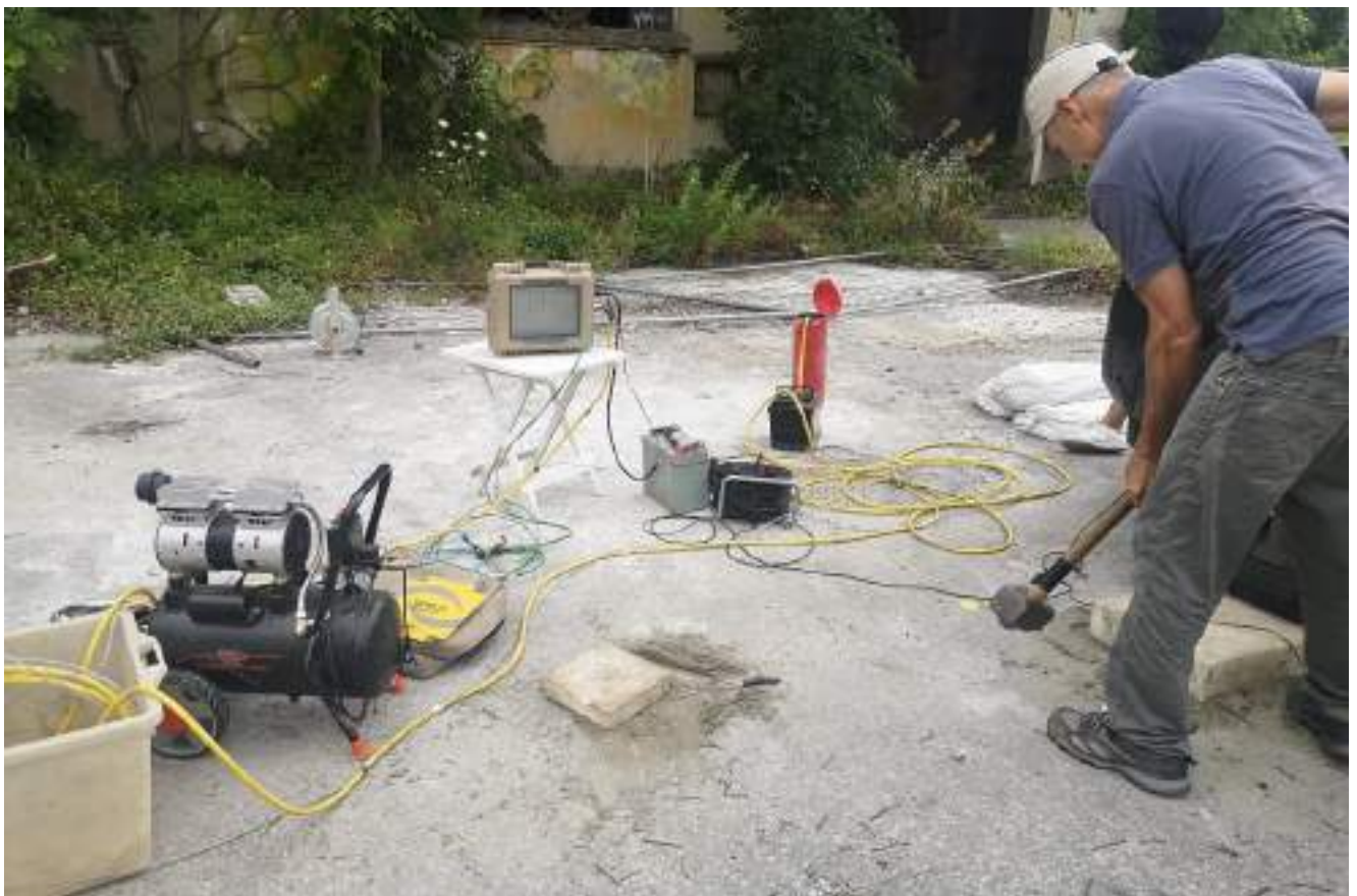
Esecuzione prova Downhole
