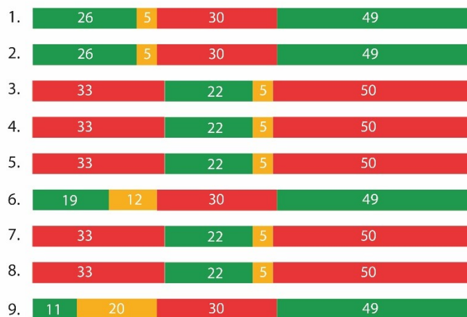
Figura 33 - Planimetria e ciclo semaforico del semaforo tra C.so Marconi e P.za Rossetti
