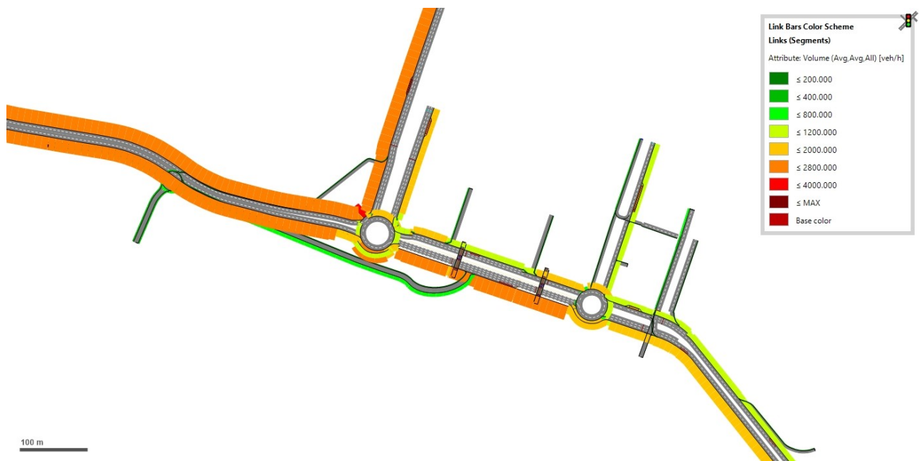
Figura 45 - Flussogramma della rete configurata secondo lo Scenario 2
