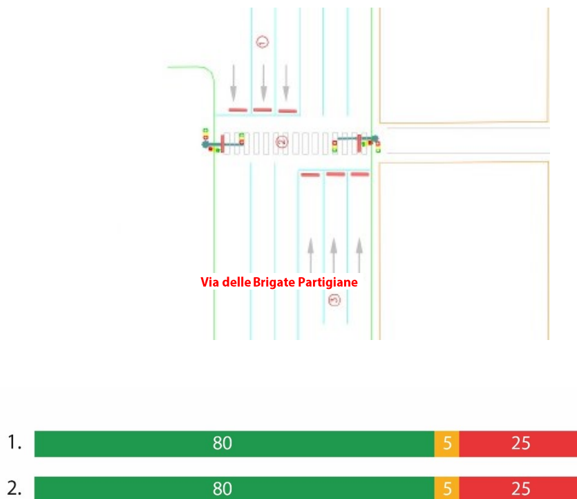
Figura 32 - Planimetria e ciclo semaforico del semaforo di Via delle Brigate Partigiane
