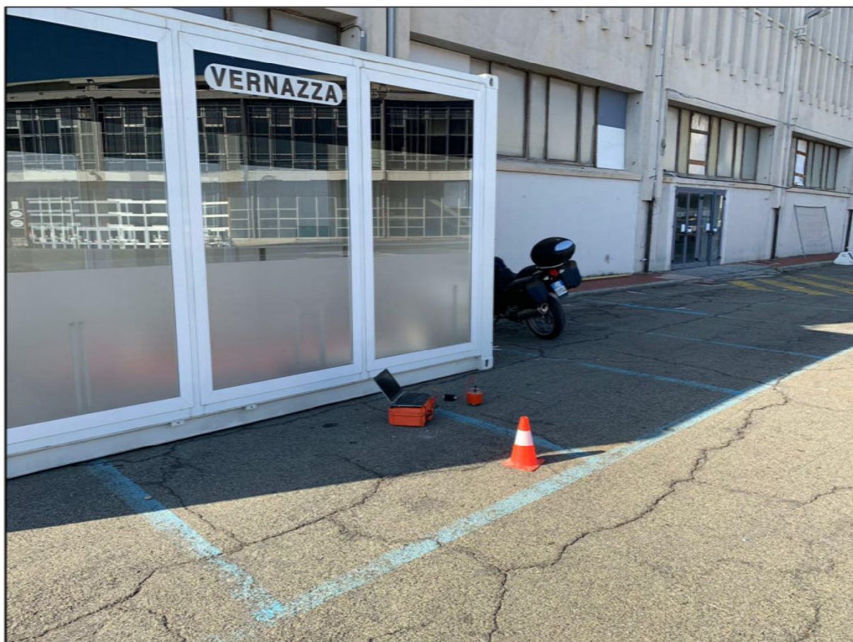
Foto 2. Esecuzione delle prove di microtremore durante la campagna di indagini dell'Ottobre 2019.
