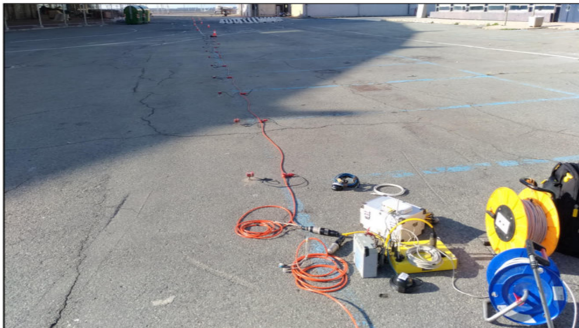
Foto 1. Immagine della stesa sismica a riflessione eseguita durante la campagna di indagini dell'Ottobre 2019.
