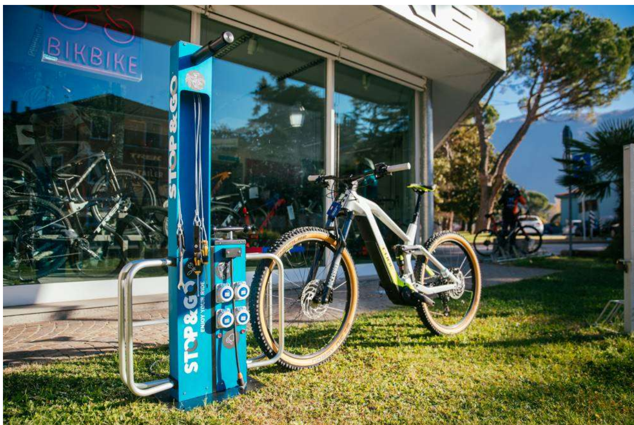
Colonnina per il ciclo riparo e con le prese per la ricarica delle bici elettriche
