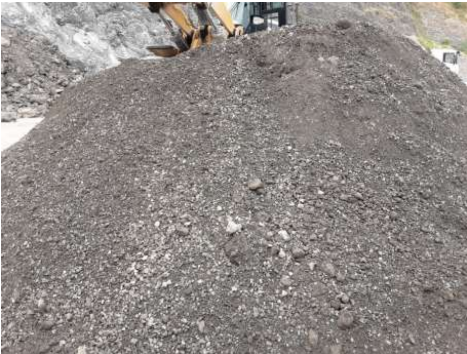
Figura 2: aspetto granulometrico della miscela di inerti preparata in cava
