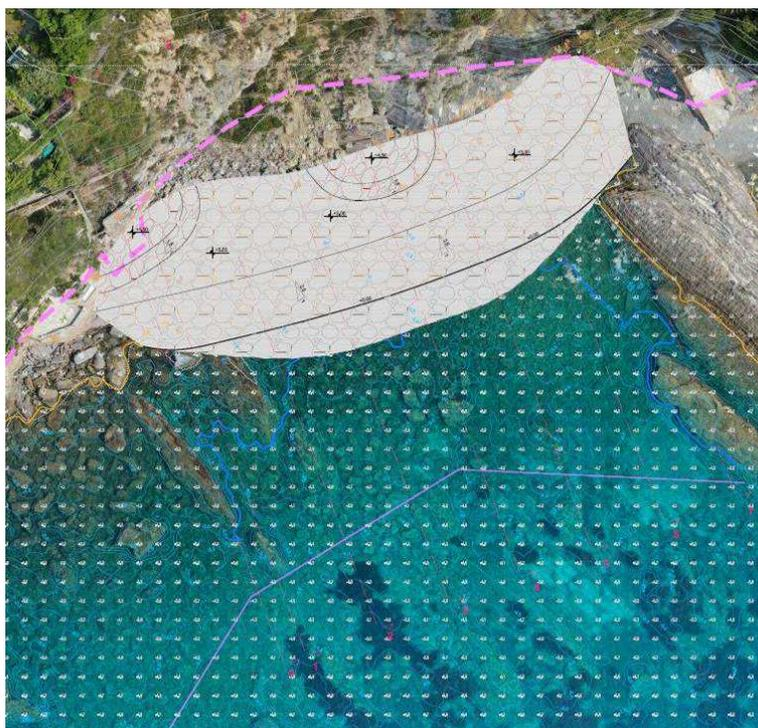
*Figura 10.1: stralcio planimetria di progetto con ortofoto e indicazione della fascia di rispetto bionaturalistica (in viola)*
