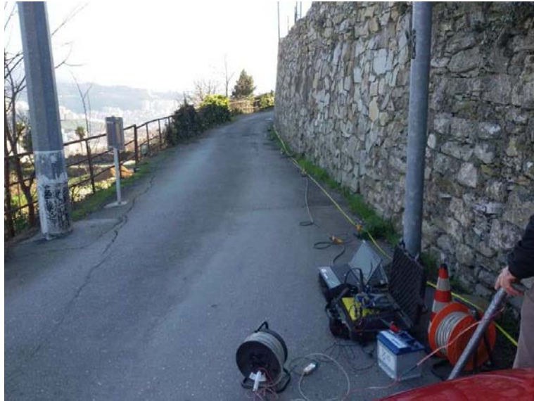
Stendimento sismico tomografico SS2, estremo finale (piastra in offset lato geofono G20)
