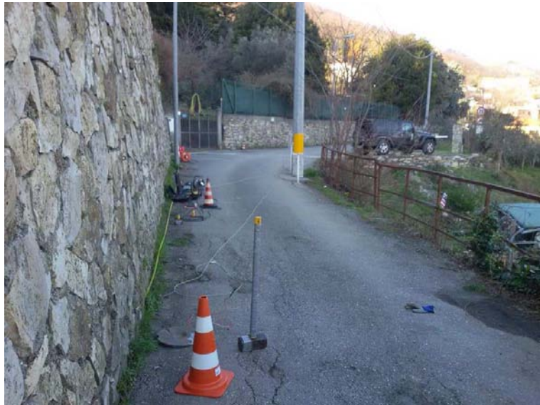
Stendimento sismico tomografico SS3, estremo iniziale (mazza e piastra in offset lato geofono G1)
