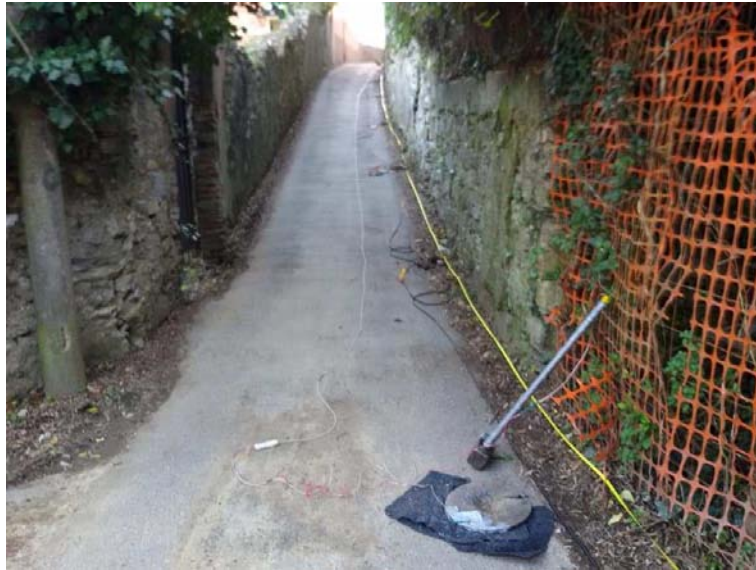
Stendimento sismico tomografico SS4, estremo finale (piastra in offset lato geofono G17)
