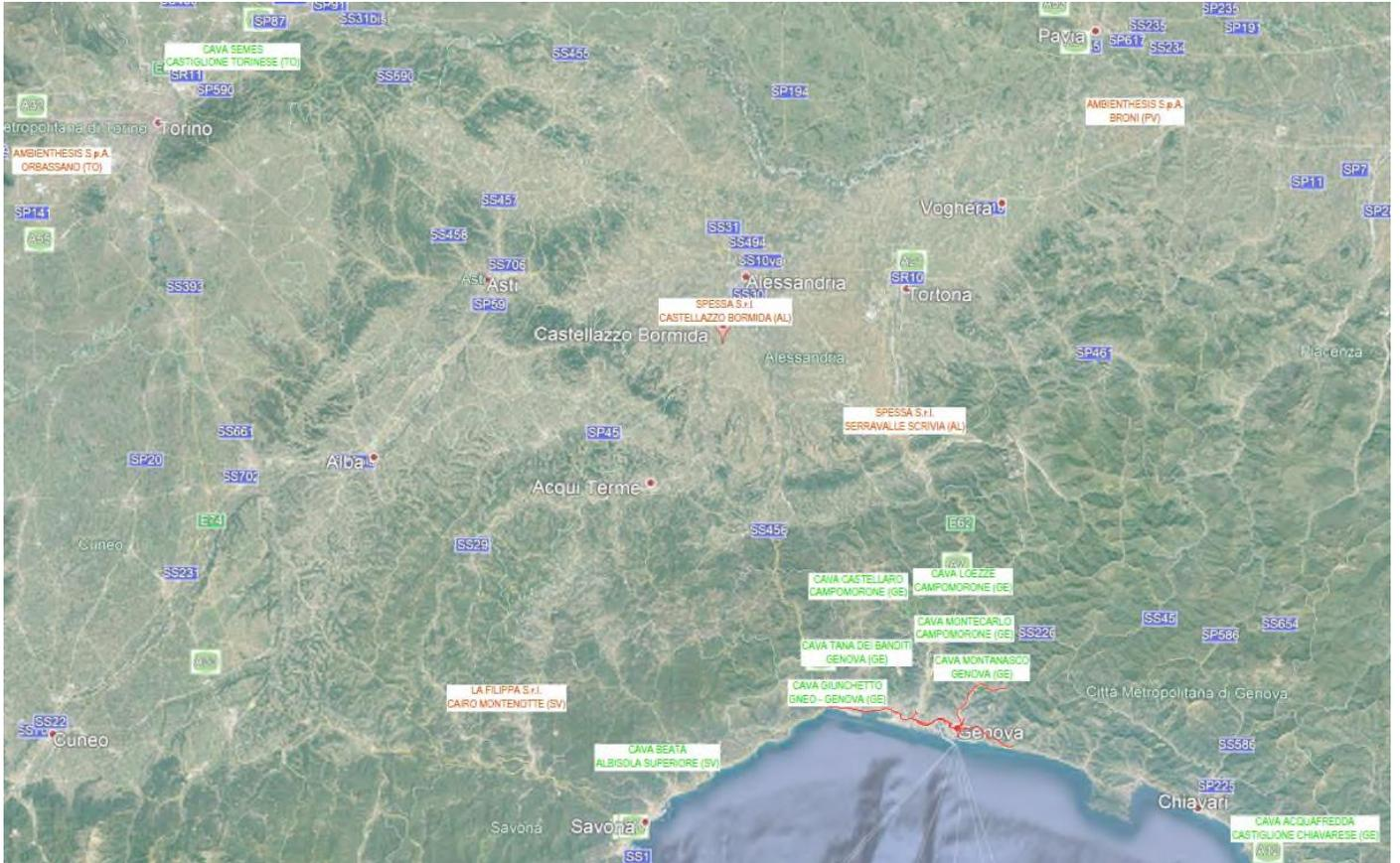
*Figura 5 percorso degli automezzi per il trasporto del materiale di scavo ai siti di destino*
