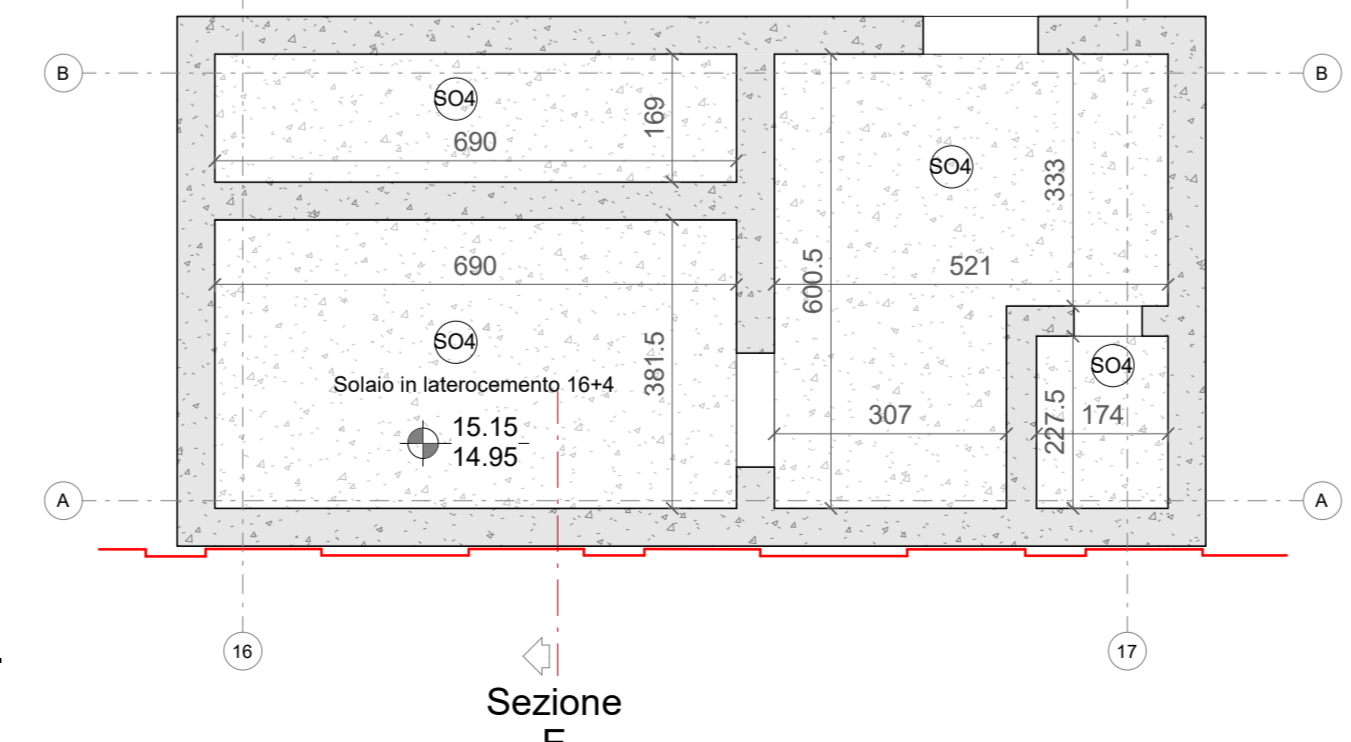
DEPOSITO - Carpenteria copertura - 3 DI 3 Scala 1 : 100
