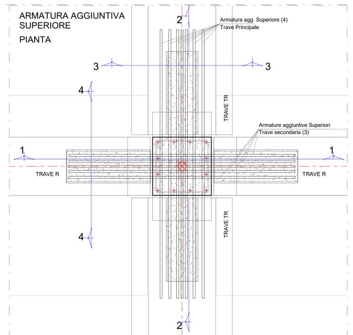
Dettaglio nodo in umido armatura superiore
