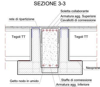
Dettaglio di connessione tettoie metalliche
