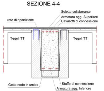
Dettaglio nodo in umido sezioni
