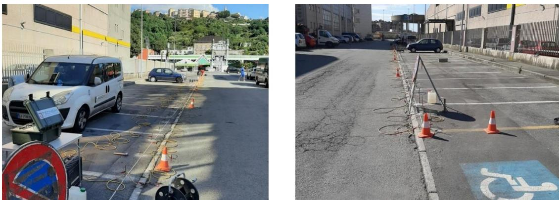
Figura 251. Foto indagine ERT sottostazione di “Campi”.
