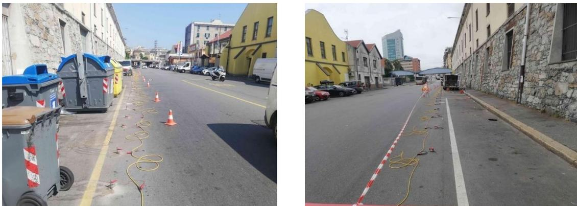
Figura 269. Foto indagine ERT sottostazione di "Degola".
