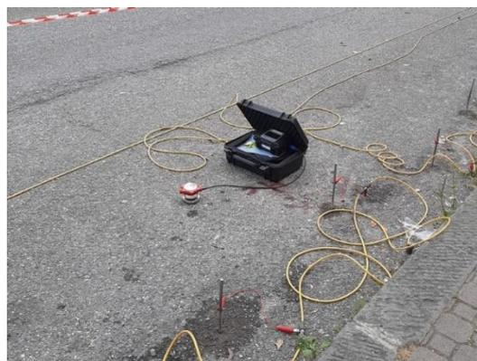
Figura 164. Foto indagine HVSR sottostazione di "Gottardo".
