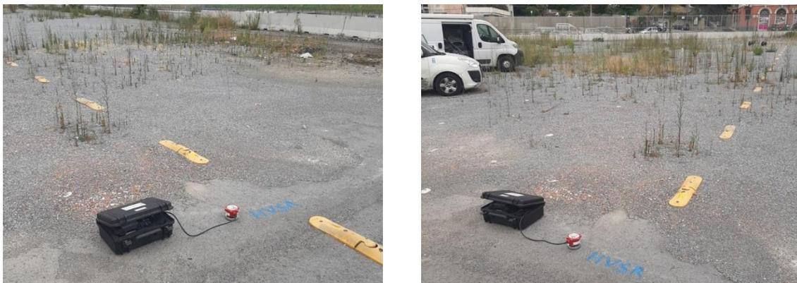
Figura 200. Foto indagine HVSr sottostazione di "via Merano".
