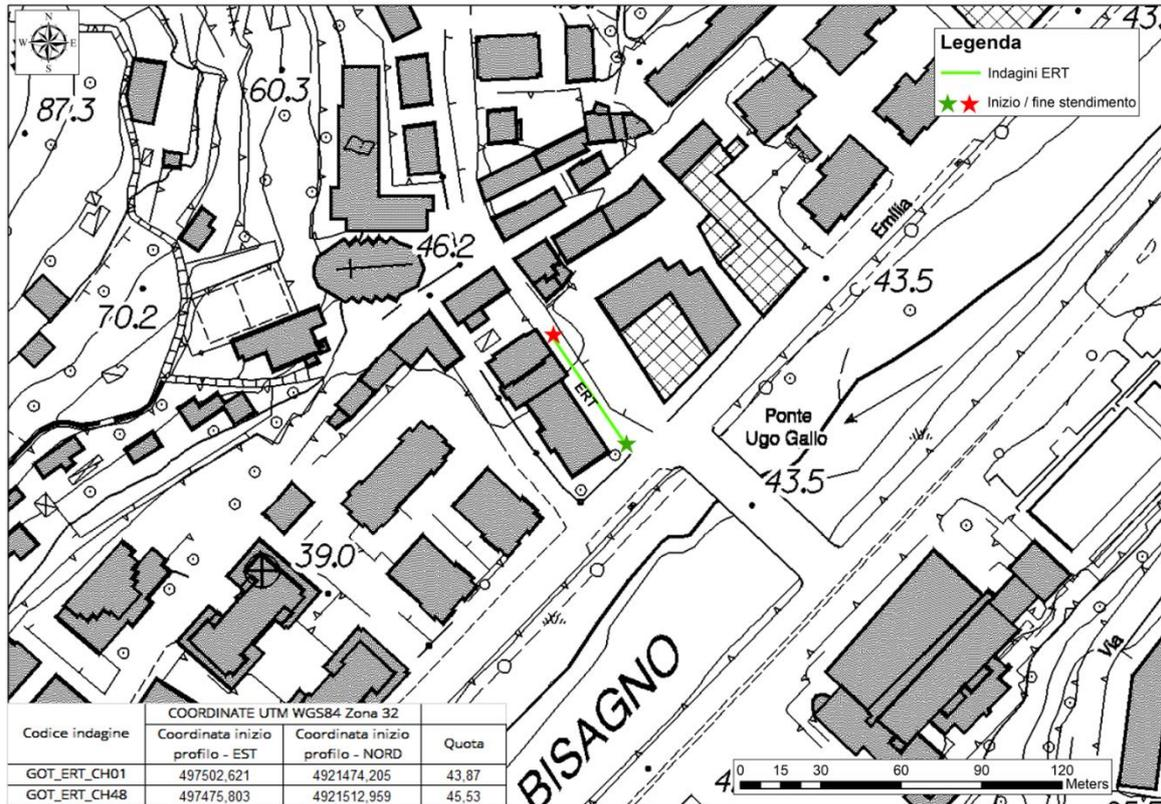
Figura 235. Ubicazione e coordinate indagine ERT sottostazione di "Gottardo".
