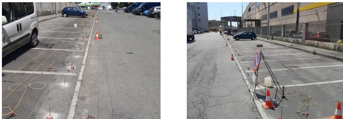
Figura 129. Foto indagine MASW sottostazione di “Campi”.
