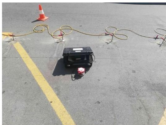
Figura 230. Foto indagine HVSr sottostazione di “Degola”.
