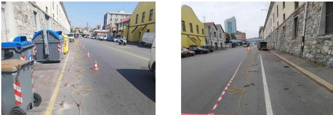
Figura 159. Foto indagine MASW sottostazione di “Degola”.
