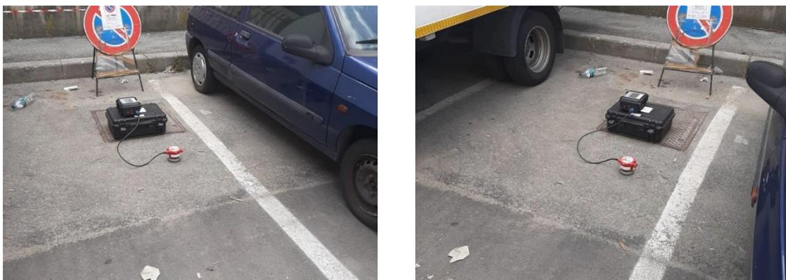
Figura 194. Foto indagine HVSr sottostazione di "Campi".
