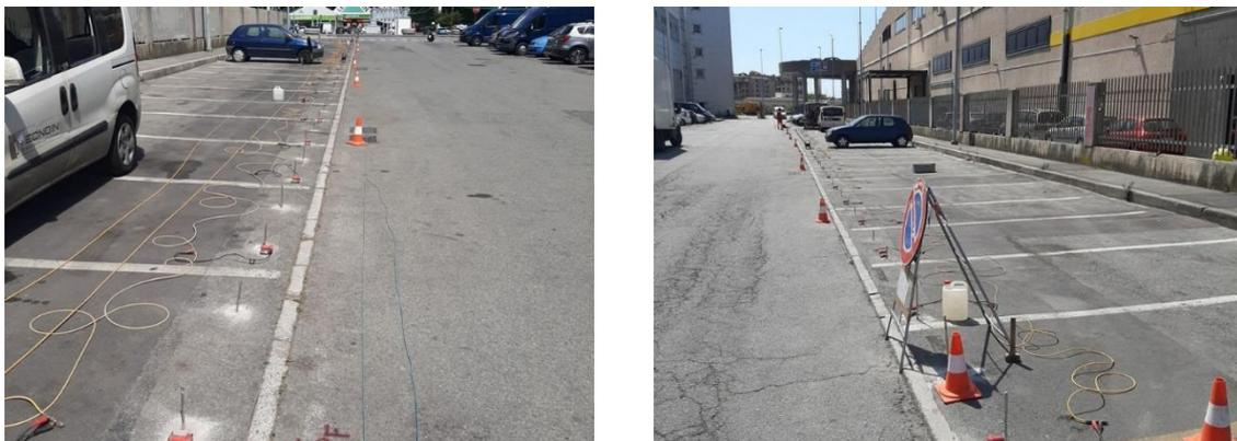
Figura 302. Foto indagine SRT sottostazione di "Campi".
