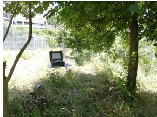
Figura 94. Foto indagini SRT deposito di "Levante".
