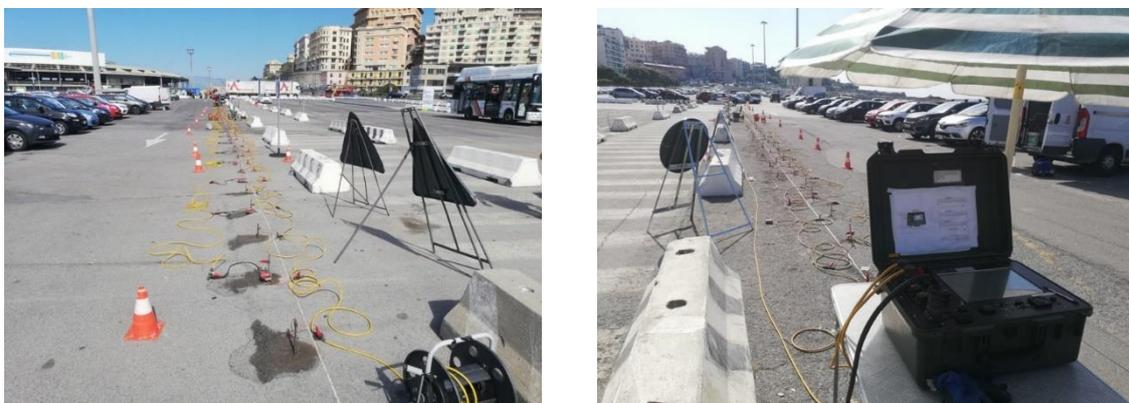
Figura 314. Foto indagine SRT sottostazione di "Kennedy".
