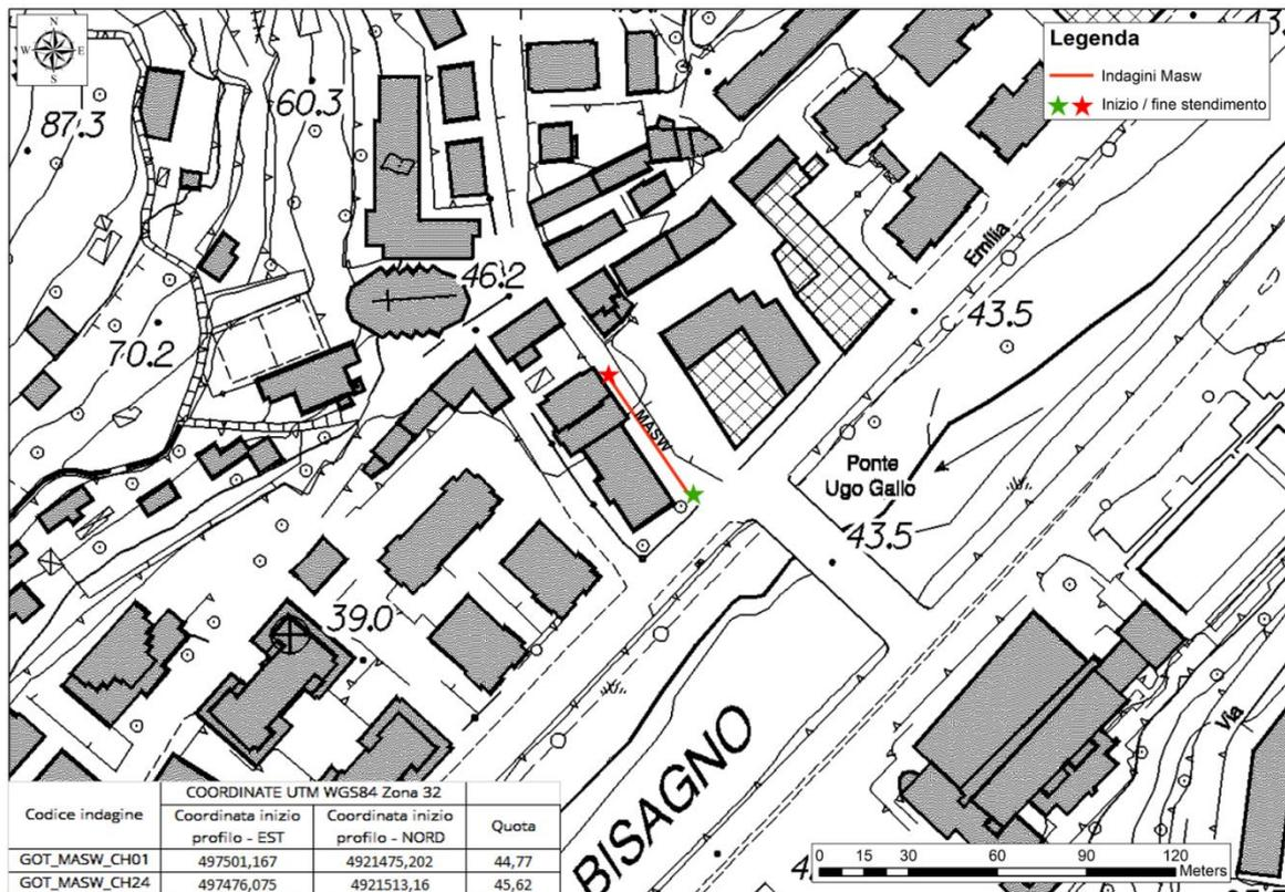
Figura 103. Ubicazione e coordinate indagine MASW sottostazione di "Gottardo".
