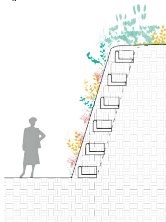
Muri verdi cellulari a gravità I muri verdi cellulari a gravità possono essere ricoperti da terra strutturale.
