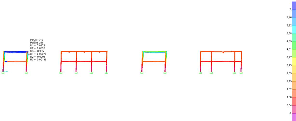
**Figura 15** Deformazione verticale [mm]
