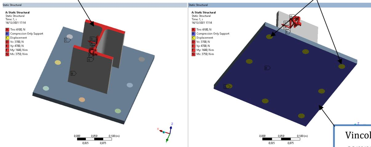
Figura 23 Modello di calcolo
