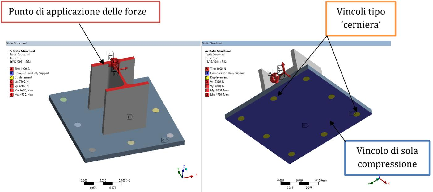
Figura 25 Modello di calcolo
