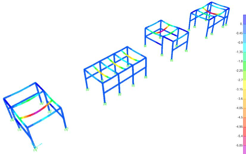
**Figura 13** Deformazione verticale [mm]
