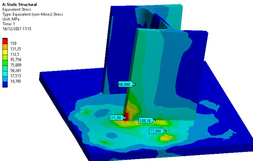
Figura 24 Tensioni di VonMises
