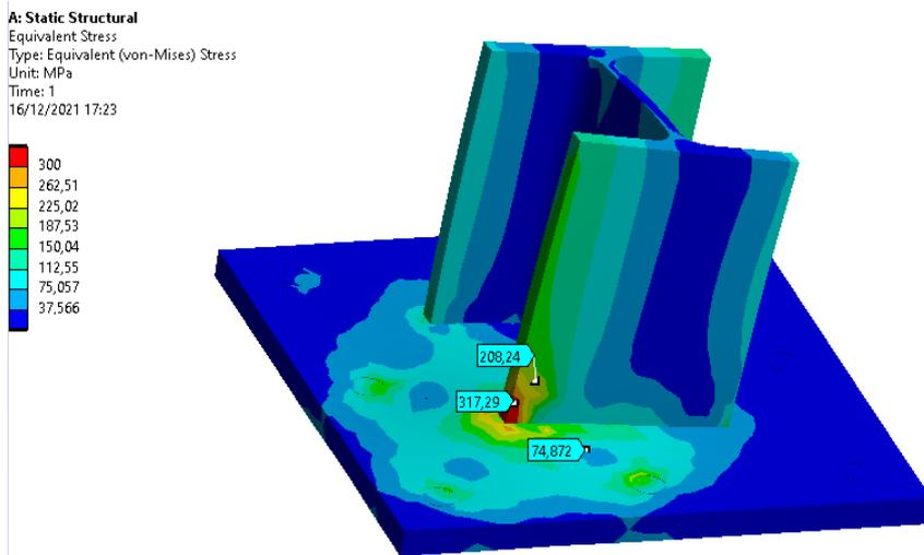
Figura 26 Tensioni di VonMises
