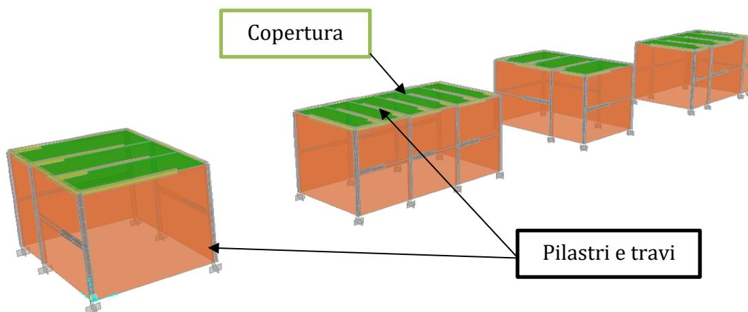
**Figura 8** Modello di calcolo carpenteria metallica
