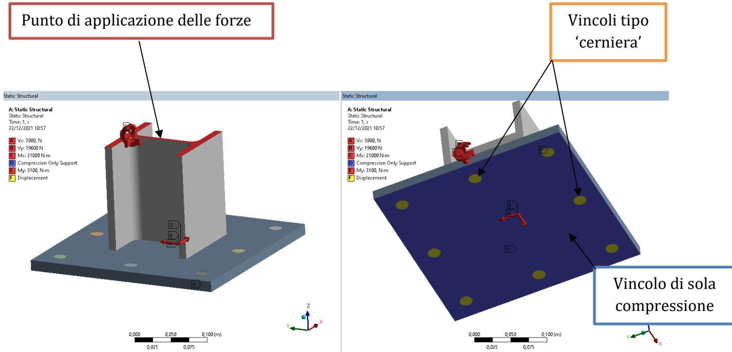
**Figura 27** Modello di calcolo
