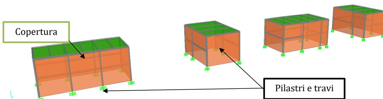
**Figura 8** Modello di calcolo carpenteria metallica
