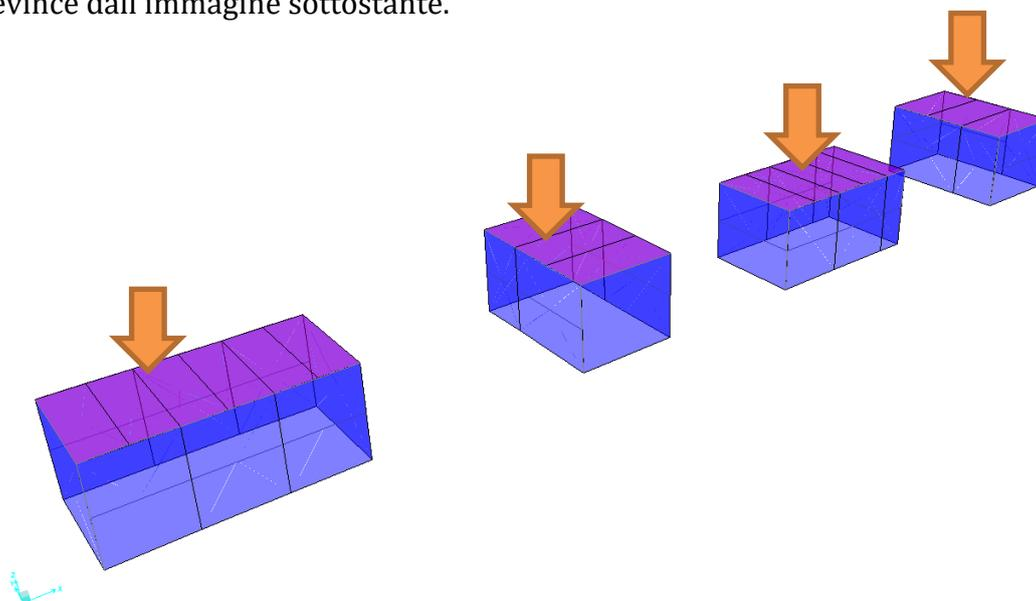
**Figura 9** Applicazione carico neve e manutenzione
