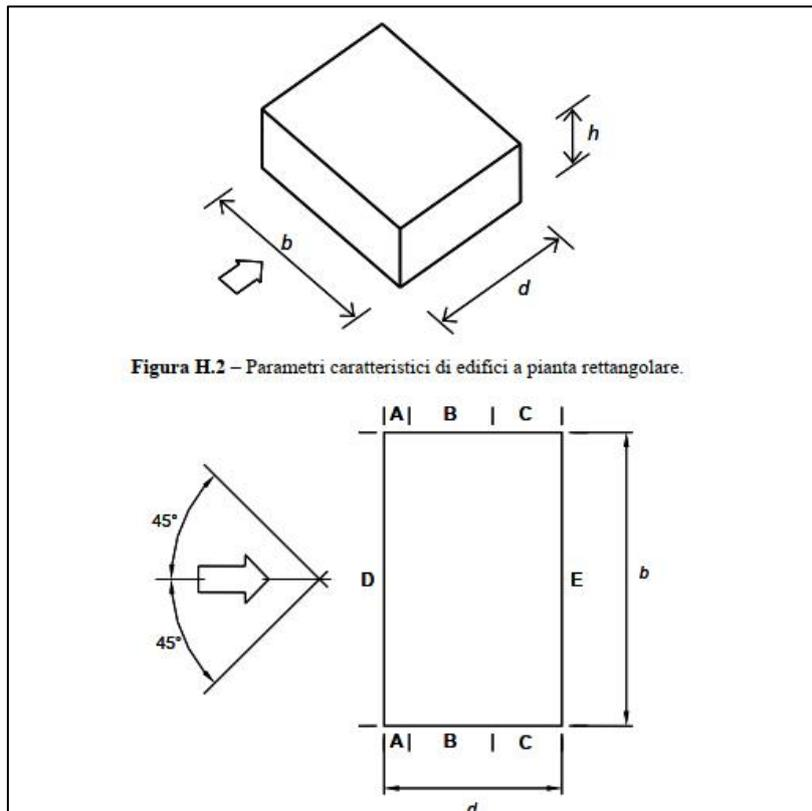
Figura H.2 – Parametri caratteristici di edifici a pianta rettangolare.
