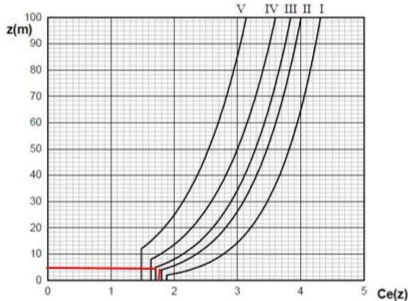
**Figura 3** Coefficiente di esposizione
