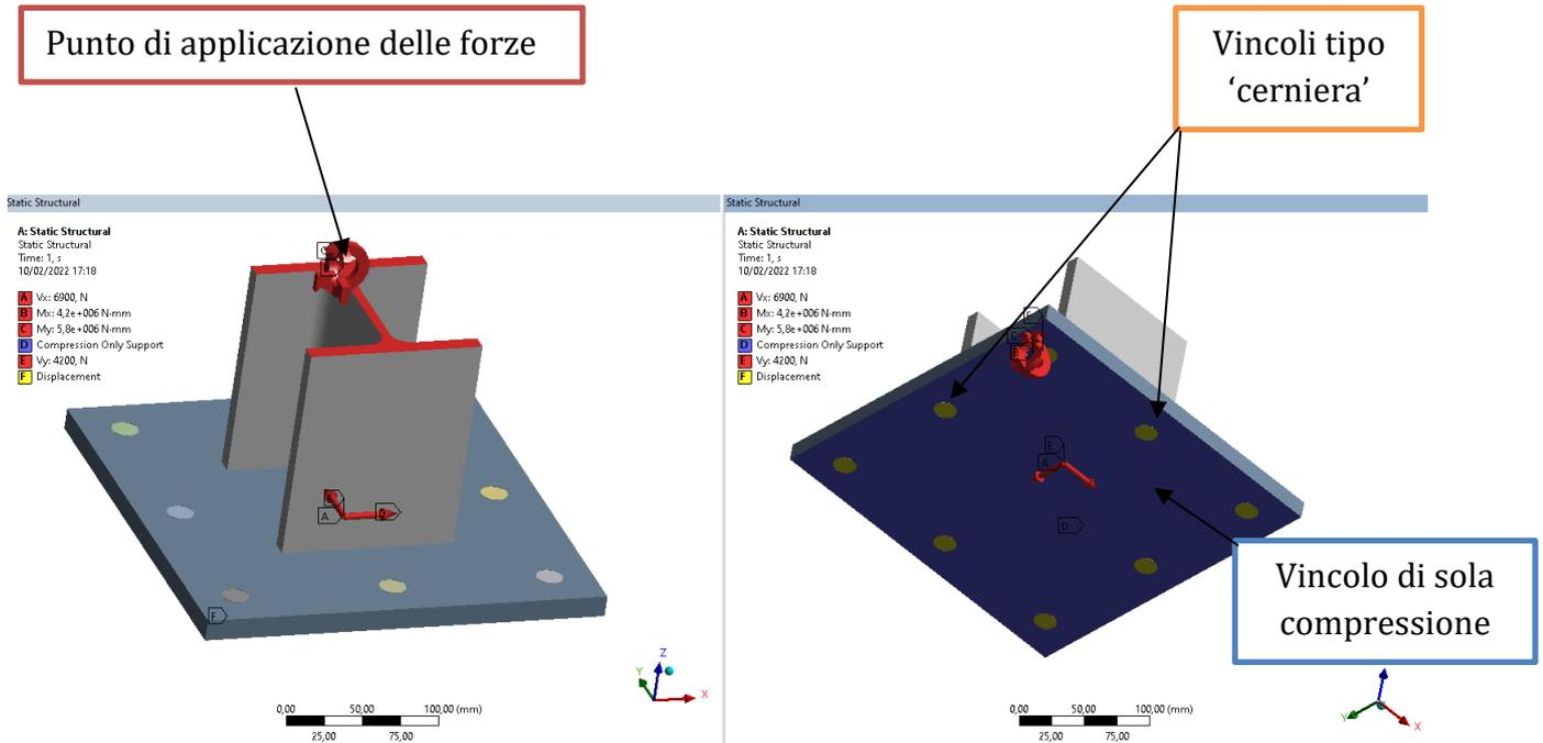
Figura 24 Modello di calcolo
