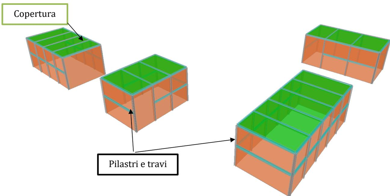
**Figura 8** Modello di calcolo carpenteria metallica
