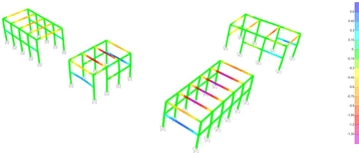
**Figura 13** Deformazione verticale [mm]
