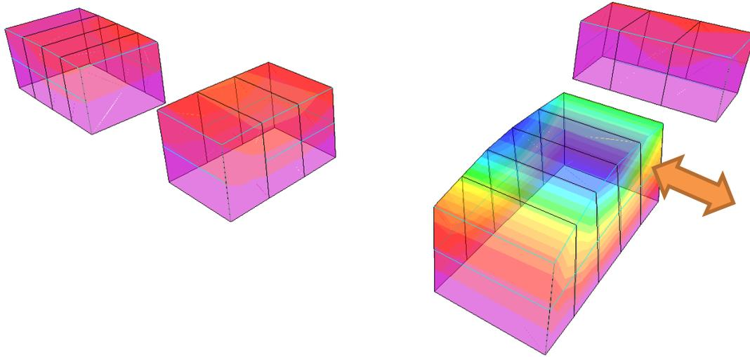
**Figura 12** Terzo modo di vibrare
