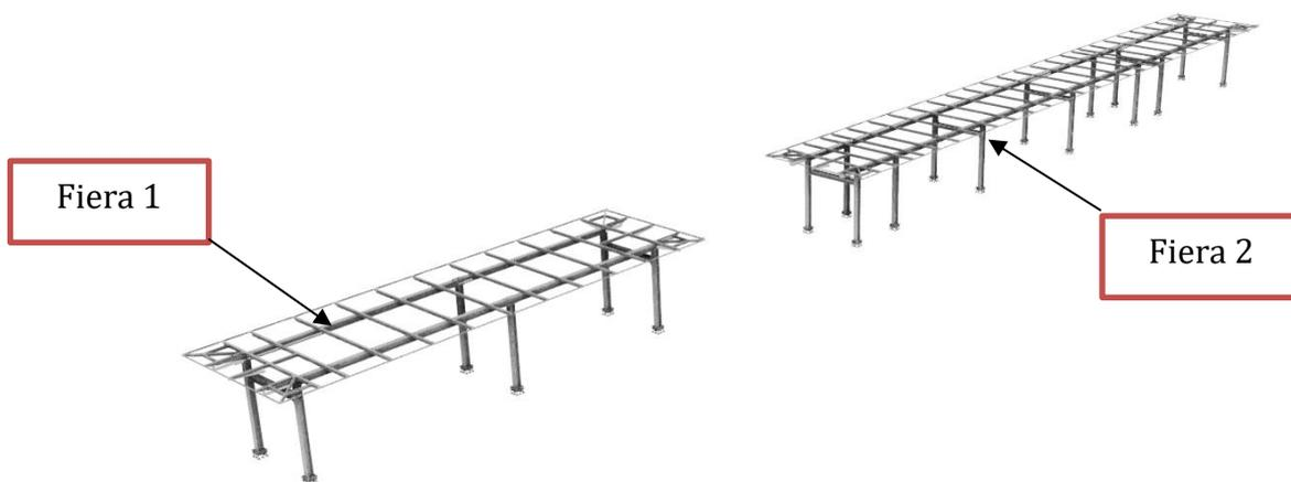
Figura 2 Vista 3d della carpenteria metallica
