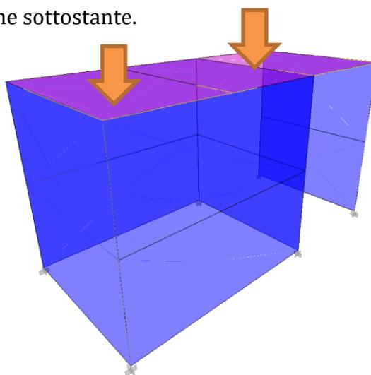
**Figura 8** Applicazione carico neve e manutenzione
