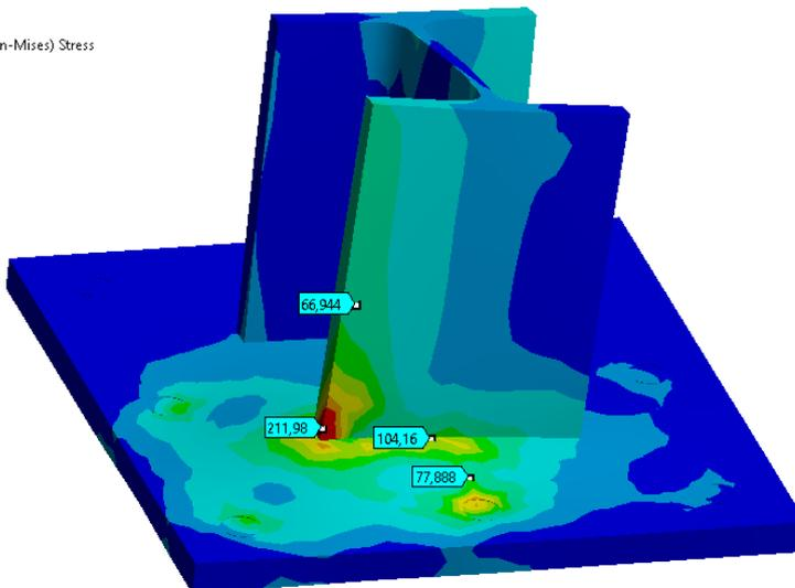
Figura 22 Tensioni di VonMises
