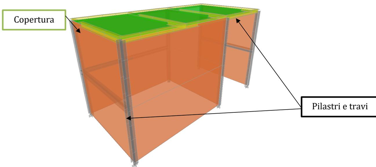
**Figura 7** Modello di calcolo carpenteria metallica
