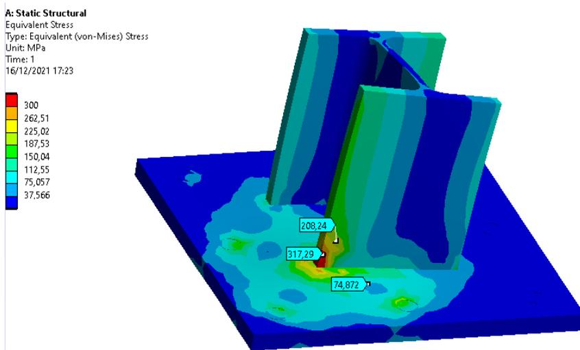
Figura 24 Tensioni di VonMises
