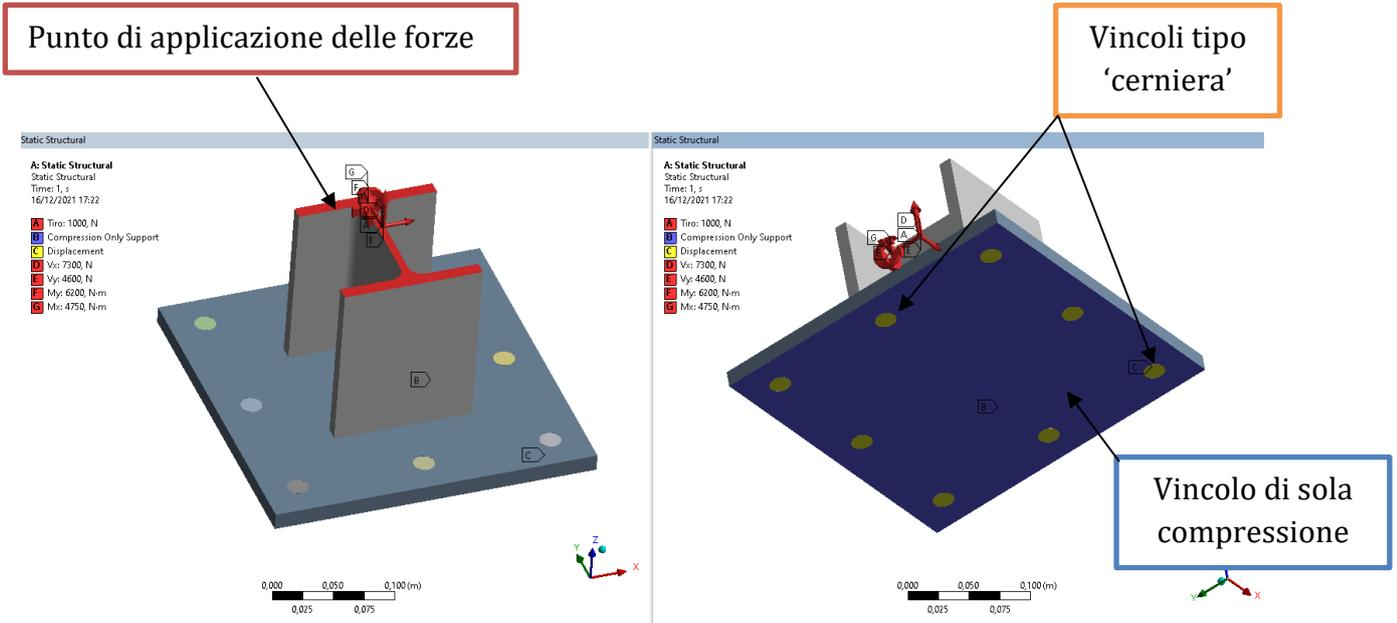
Figura 23 Modello di calcolo
