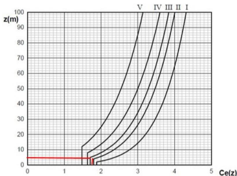
**Figura 2** Coefficiente di esposizione
