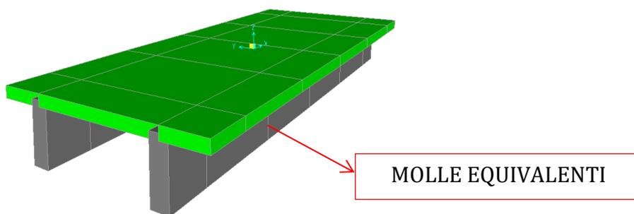
L'iterazione tra la struttura di fondazione e il terreno è stata condotta tramite il modello di Winkler. Il calcolo della rigidezza da assegnare alla molla è condotto calcolando prima il cedimento medio al di sotto del centro della fondazione. Noto il cedimento si calcola la rigidezza della molla con il rapporto tra il carico distribuito presente sulla platea ed il cedimento
