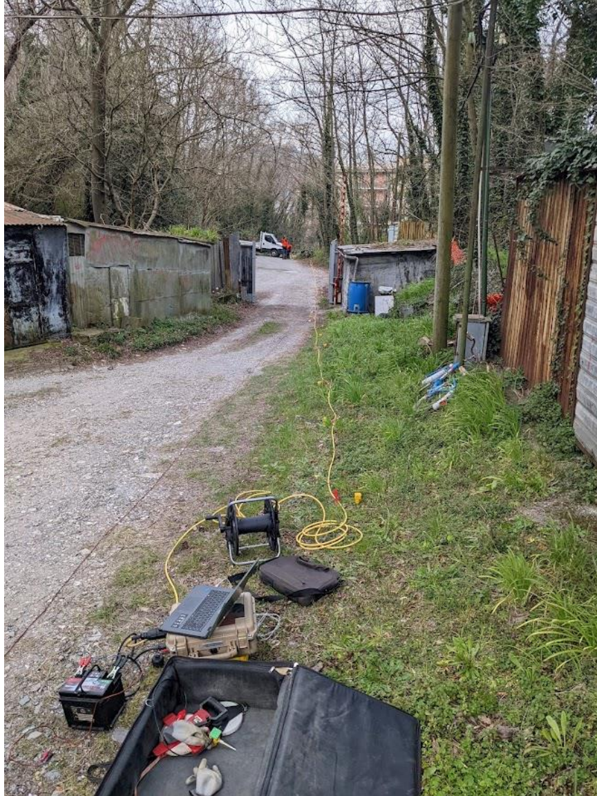
Figura 3 – Stendimento sismico per la prova MASW1. Lo stesso stendimento è stato utilizzato per acquisire i dati di Re.Mi. 1 e sismica a rifrazione Rifr1.
