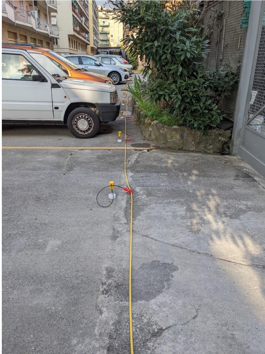
Figura 5 – Stendimento sismico per la prova MASW3. Lo stesso stendimento è stato utilizzato per acquisire i dati di Re.Mi. 3 e sismica a rifrazione Rifr3.
