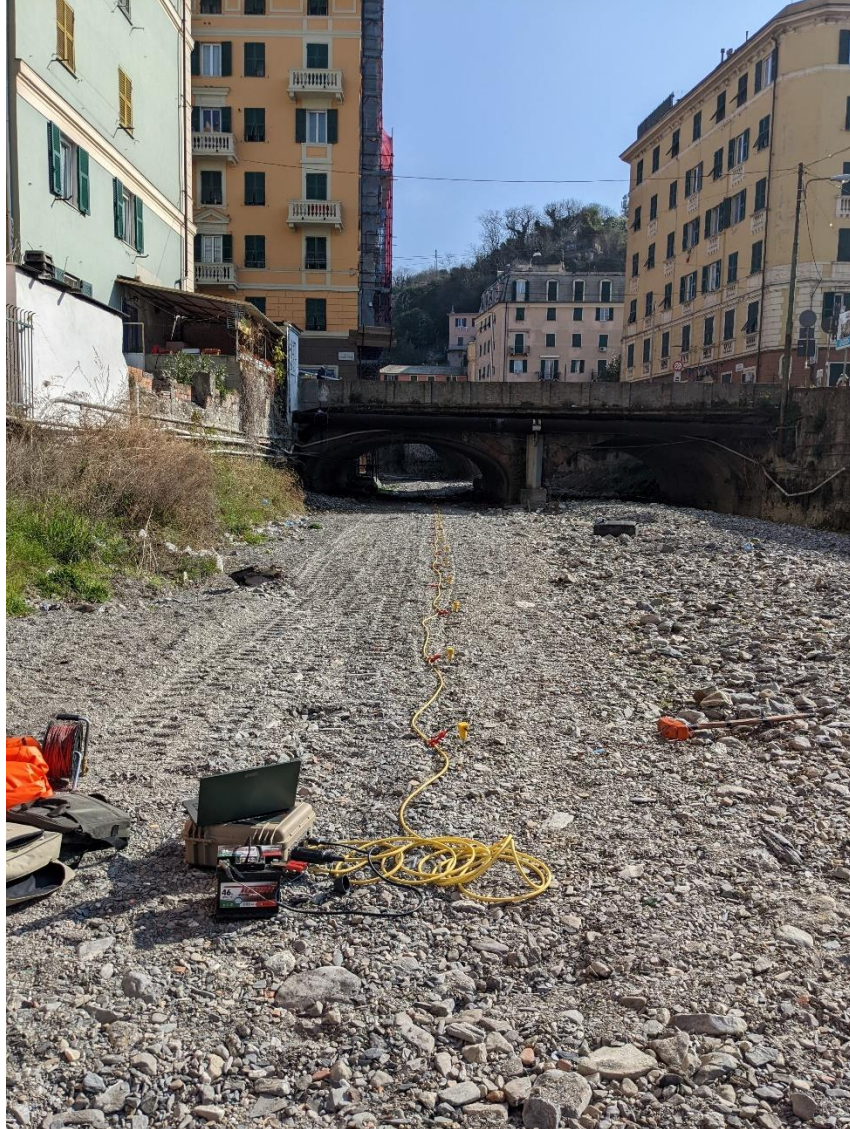
Figura 6 – Stendimento sismico per la prova MASW4. Lo stesso stendimento è stato utilizzato per acquisire i dati di Re.Mi. 4.
