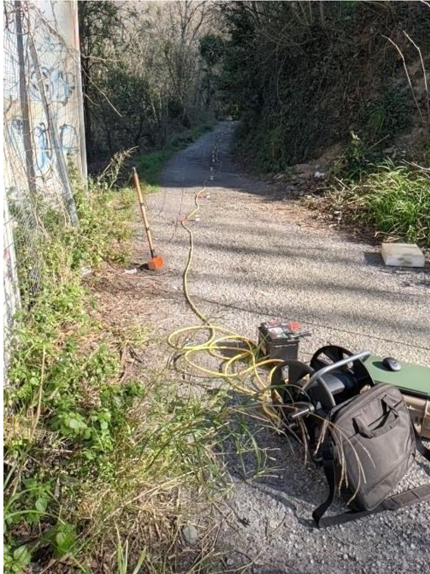
Figura 4 – Stendimento sismico per la prova MASW2. Lo stesso stendimento è stato utilizzato per acquisire i dati di Re.Mi. 2 e sismica a rifrazione Rifr2.
