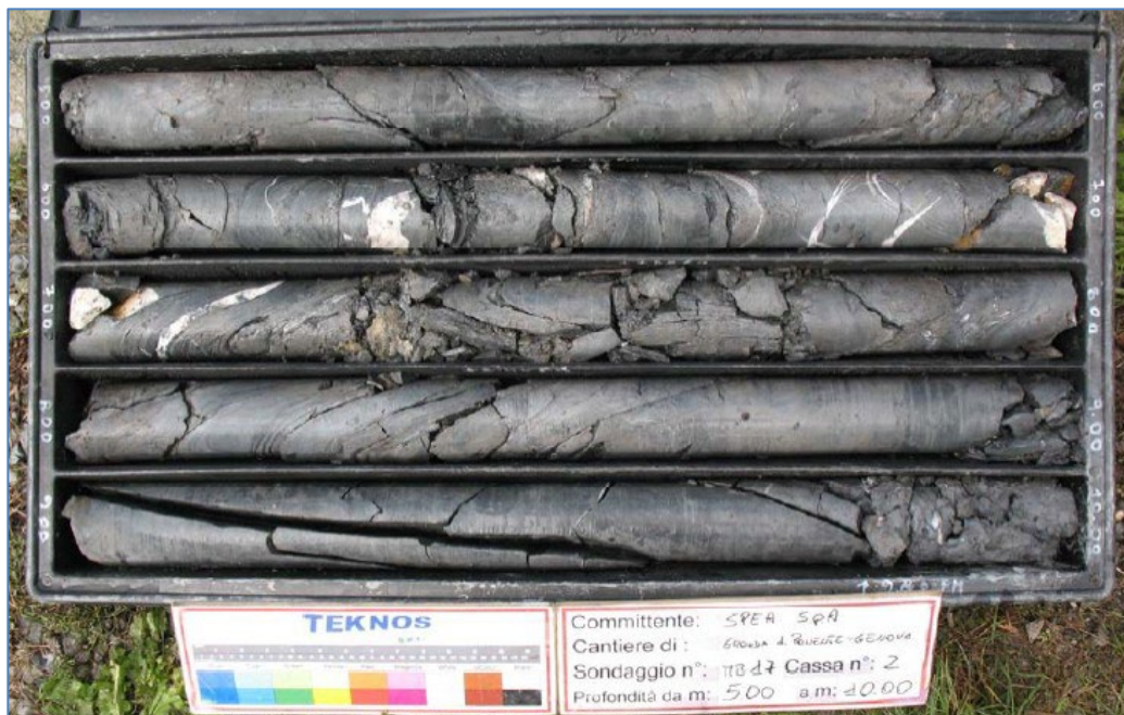
Figura 10.1 Canale di gronda. Sondaggio M17 nella Argilliti di Montanesi
