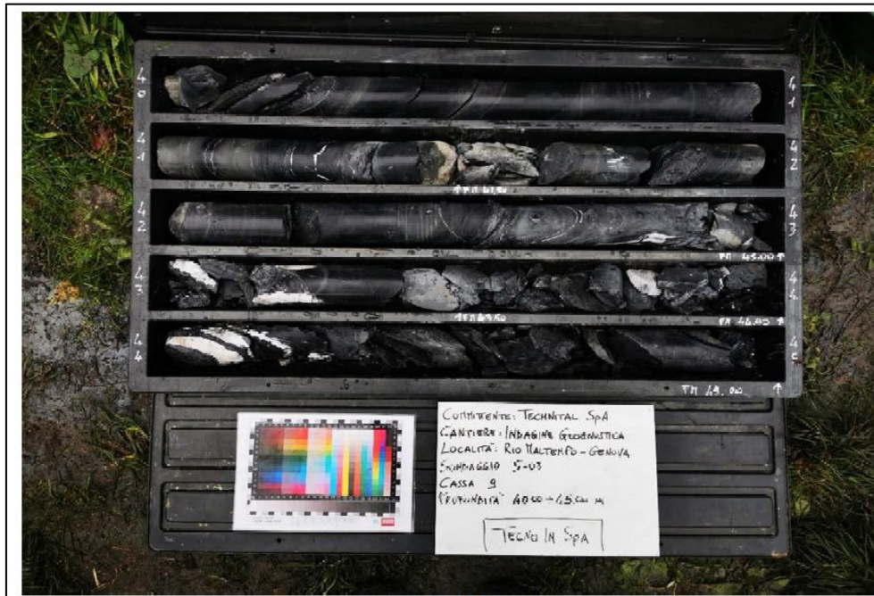
Figura 10.9 Sondaggio S03. Argilliti a quota galleria
