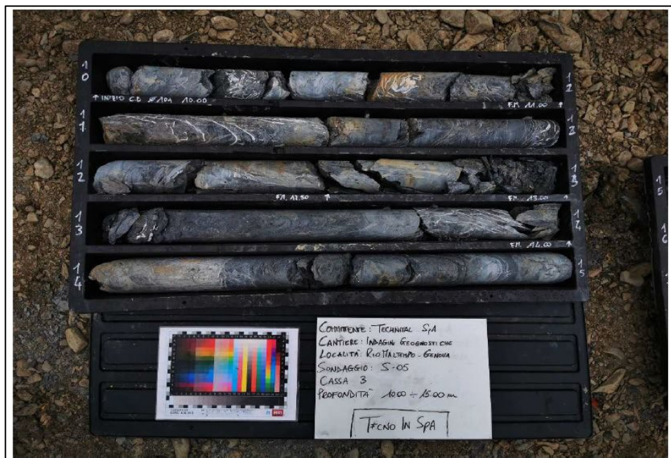
Figura 10.10 Sondaggio S05. Substrato argillitico fra 10-15 m da p.c.
