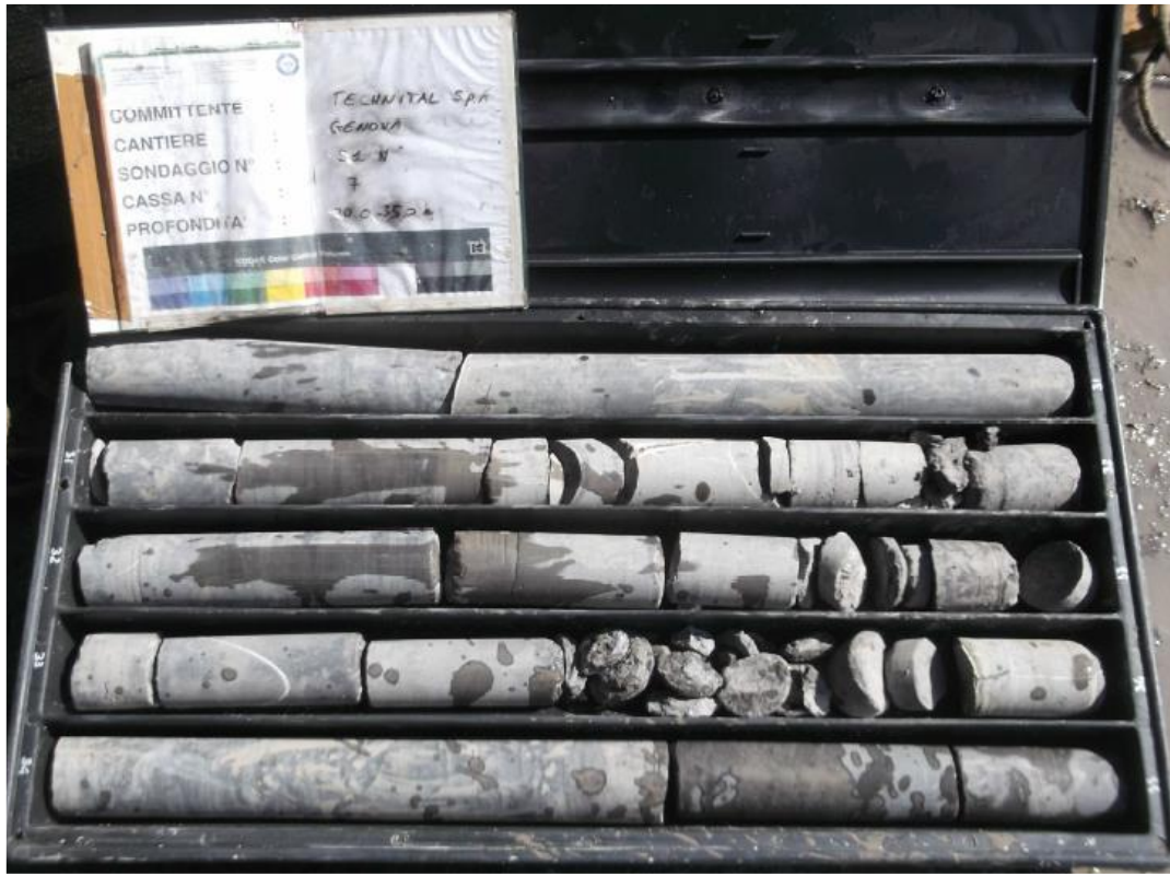
Figura 6.4 - Unità III tra 30 – 35 m dal p.c. nel sondaggio S1N
