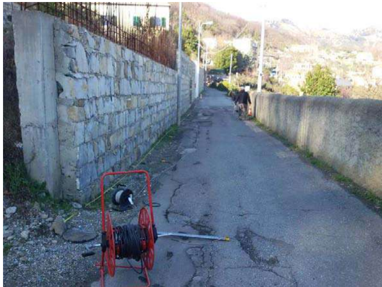
Stendimento sismico tomografico SS2, estremo iniziale (mazza e piastra in offset lato geofono G1)
