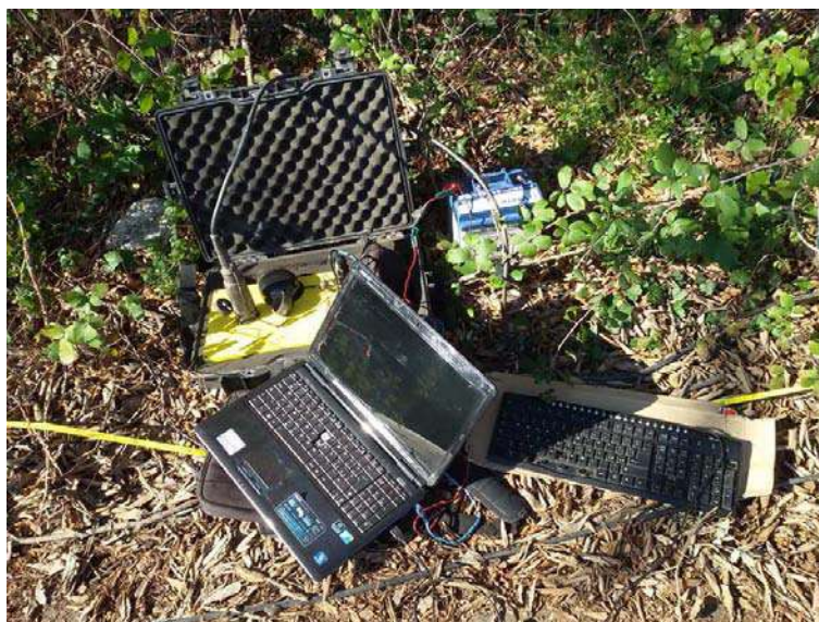
Sistema di acquisizione Seismic Source Daq Link III
