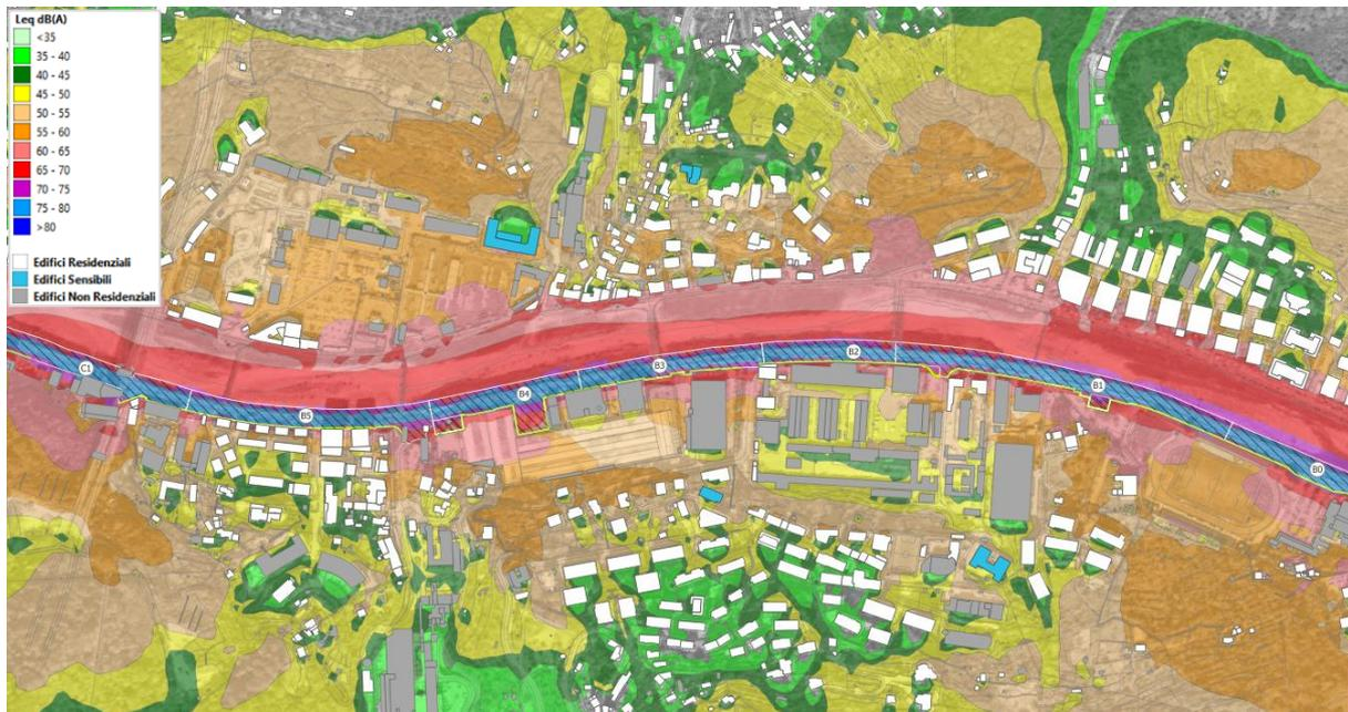
Figura 29. Mappa di simulazione acustica – Scenario 2b Post Mitigazione
