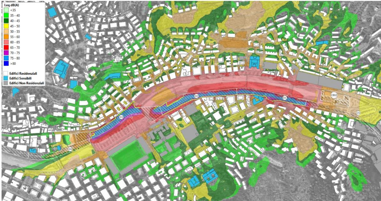
Figura 28. Mappa di simulazione acustica – Scenario 2b Post Mitigazione
